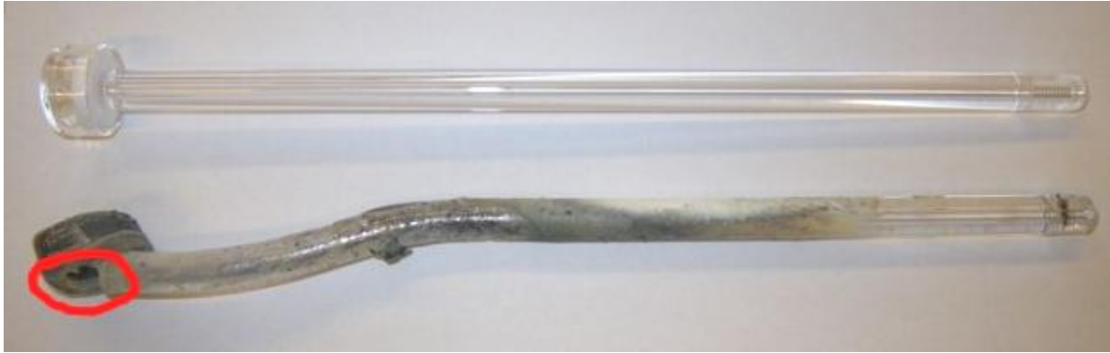
Abbildung 37: Spülgaslanze; oben: neu/unten: nach 20 min Begasung
