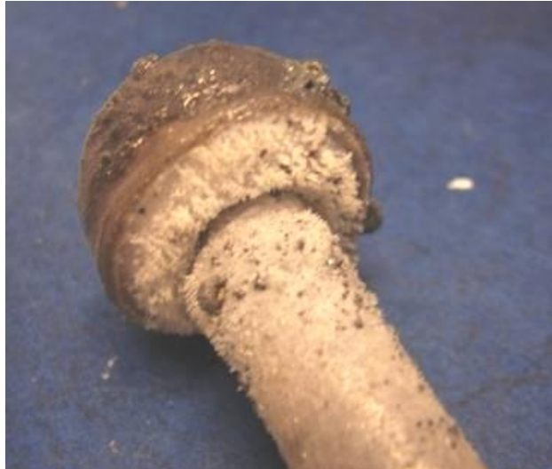
Abbildung 46: Typische Schäden an der Spülfritte nach den Versuchen
