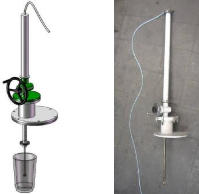
Abbildung 38: Spülgassystem; links: CAD-Skizze; rechts: Foto (ohne Graphitkuppung und Lanze)
