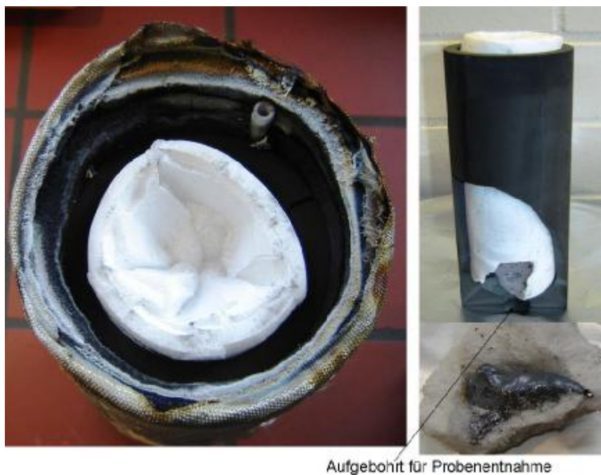
Abbildung 11: Typischer Quarz-/Graphittiegelbefund mit Spule I
