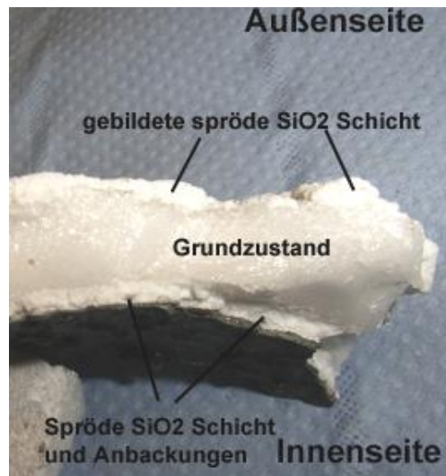
Abbildung 47: Bruchstück des Tiegels nach zwei Schmelzen
