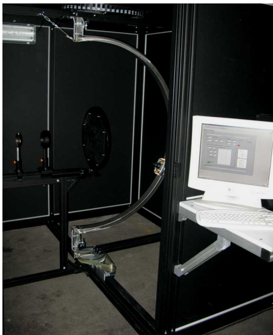
Abbildung 6-8: ISFH-Photogoniometer zur Bestimmung des Leuchtdichtekoeffizienten lichtstreuender Verglasungskomponenten (links) und schematische Darstellung des verwendeten Koordinatensystems (rechts)
