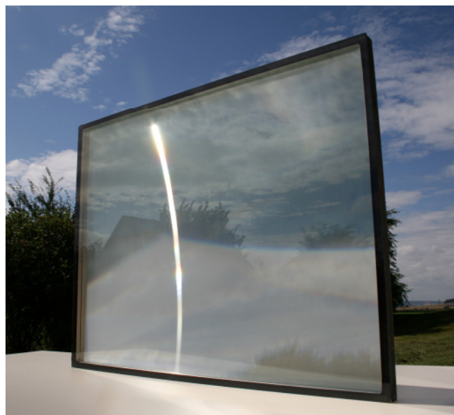
Abbildung 5-1: Aufbau und Ansicht eines großformatigen Prototyps (840 x 670 mm) für den Einsatz als TWD-Modul
