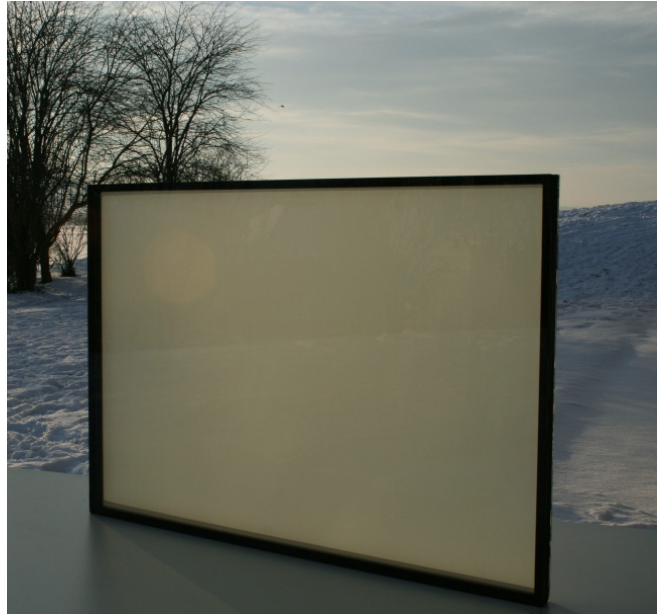
Abbildung 5-2: Aufbau und Ansicht eines großformatigen Prototypes (830 x 570 mm) mit integrierter lichtstreuender Innenglasscheibe für den Einsatz als Lichtelement
