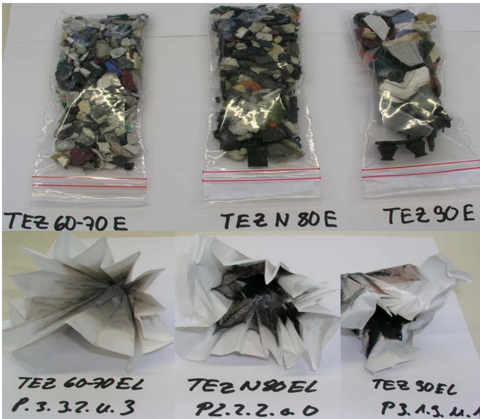
Abbildung 14: Proben aus dem Wietek-Löseverfahren (Ausgangsmaterialien: oben; Filterrückstand: unten)
