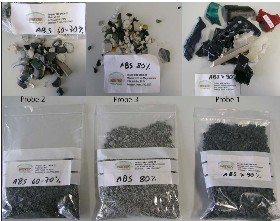
Abbildung 13: Proben vor dem Löseverfahren (oben) und nach dem Löseverfahren (unten)
