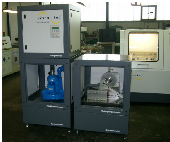
Abb. 9: Der modulare Aufbau der Anlage (vorn im Bild) gestattet, flexibel auf die vor Ort vorhandenen Raumverhältnisse zu reagieren. Das Reinigungsmodul kann getrennt von den übrigen Modulen aufgestellt werden. Die Module, die starken Vibrationen ausgesetzt sind, verfügen jeweils über ein Sockelmodul, das mit Sand gefüllt wird und die Eigenfrequenz des mechanischen Aufbaus so absenken, daß keine Resonanzbelastungen mehr auftreten können und eine sichere Aufstellung gewährleistet ist.
