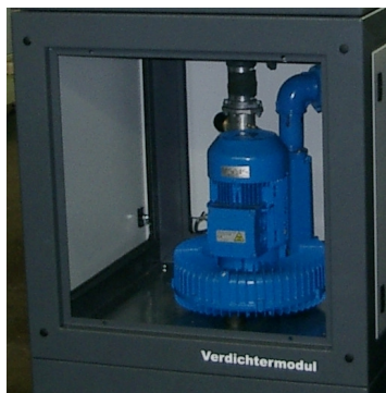
Abb. 20: Das Verdichtermodul enthält den Seitenkanalverdichter mit Motor und Steuerung.
