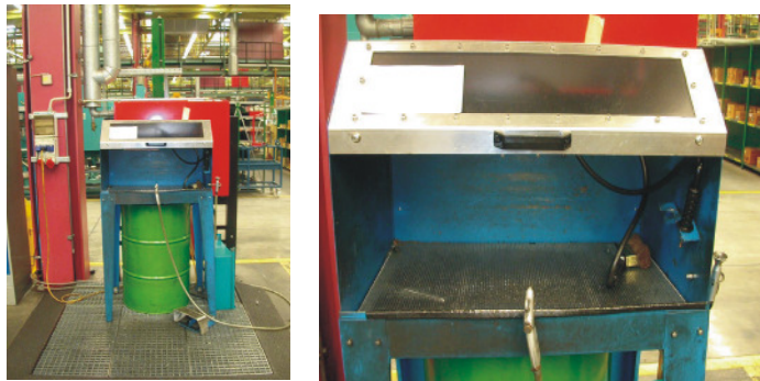
Abb. 12 und 13: Tägliche Praxis: Zentrale Waschstationen – handbetrieben – erzeugen lange Wege und schaffen verschmutzte Arbeitsplätze in vielen Betrieben. Neben den teilweise offen betriebenen Waschstellen, in denen Teile mit Sacklöchern und zerklüfteter Oberfläche mittels Preßluft ausgeblasen werden, sind flächige Verschmutzungen des Betriebes und der Mitarbeiter nicht zu verhindern.
