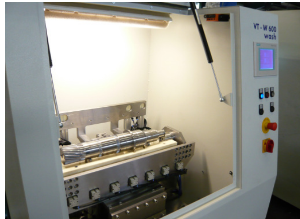
Abb. 1: Der Projektleiter, Dipl.-Ing. Klaus Döhner weist auf die geöffnete Reinigungskammer, bestehend aus den Formbacken (weißer Kunststoff). Die Zentrierung und der Antrieb des Reinigungsgutes erfolgt über die links und rechts befindlichen Werkstückaufnahmen.
