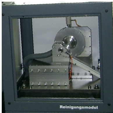
Abb. 19: Das Reinigungsmodul – hier aus Demonstrationsgründen mit einer Makralon-Scheibe versehen – beherbergt die mechanische Zuführung (kreisförmige Kammer), den Vibrationsraum mit der Auslaßführung (schiefe Ebene) sowie den Vibrationsantrieb unterhalb der Vibrationskammer.
