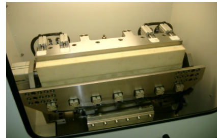
Abb. 5: Das obere Formteil ist heruntergefahren und die Reinigungskammer damit geschlossen.
