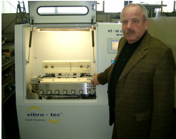
Abb. 1: Der Projektleiter, Dipl.-Ing. Klaus Döhner weist auf die geöffnete Reinigungskammer, bestehend aus den Formbacken (weißer Kunststoff). Die Zentrierung und der Antrieb des Reinigungsgutes erfolgt über die links und rechts befindlichen Werkstückaufnahmen.
