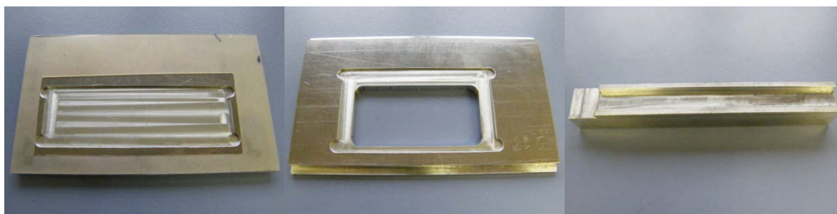
Abbildung 18: Einzelteile des Gehäuses für den Photomikroreaktor von links nach rechts: Unterseite mit Silikondichtung, Oberseite, seitlicher Verbinder
