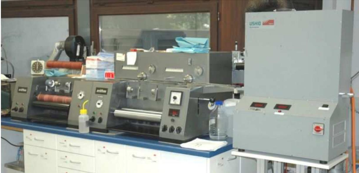
Abbildung 1: Prüfbau Probedruckgerät mit UV-Trockner (Sensitometer).
