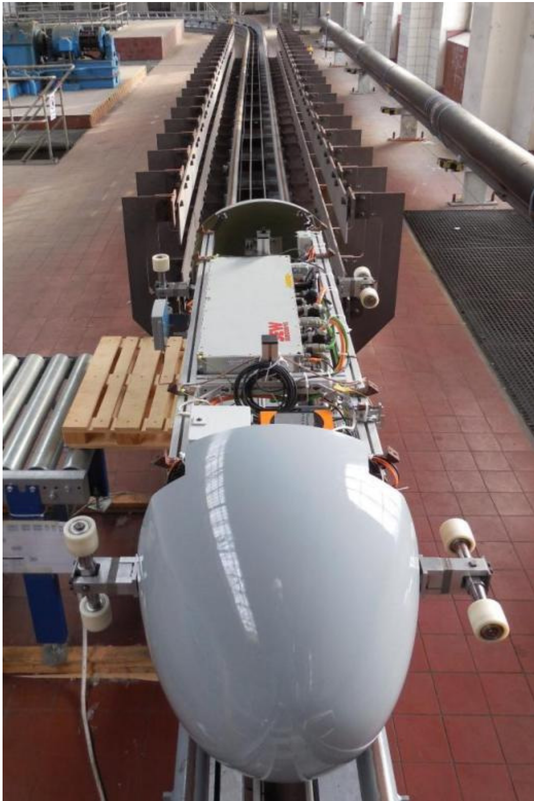
Abbildung 4.6: Modellstreckenfahrzeug mit schaltenden Weichenmodulen und Verzweigungsprüfstand (im Hintergrund) sowie Be-/Entladung einer Modellpalette
