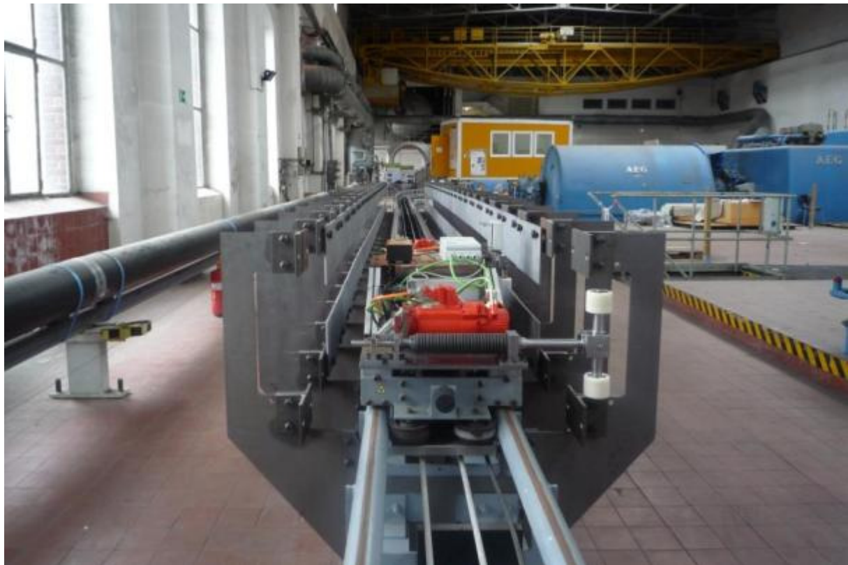
Abbildung 4.1: Modellstreckenfahrzeug mit nicht schaltenden Weichenmodulen innerhalb des Verzweigungsprüfstands
