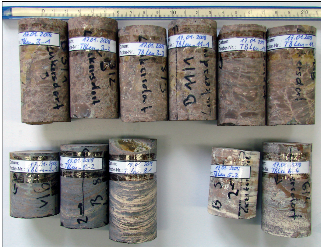
Bild 3.8b: Prüfkörper des Tagebaues Leukersdorf (Rhyolith, Rhyolith-Pyroklastite mit verschiedenen Korngrößen)
