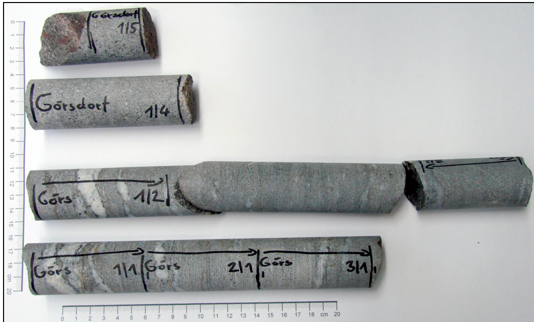
Bild 3.6: Prüfkörper des Tagebaues Görzdorf (Gneis)
