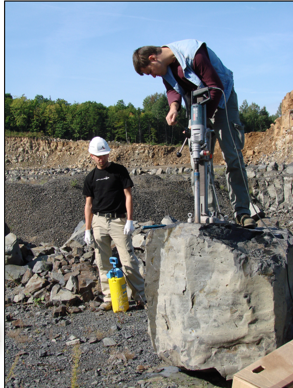
Bild 3.2: Einsatz eines Kernbohrgerätes zur Prüfkörperherstellung für das UKS-D-Messgerät
