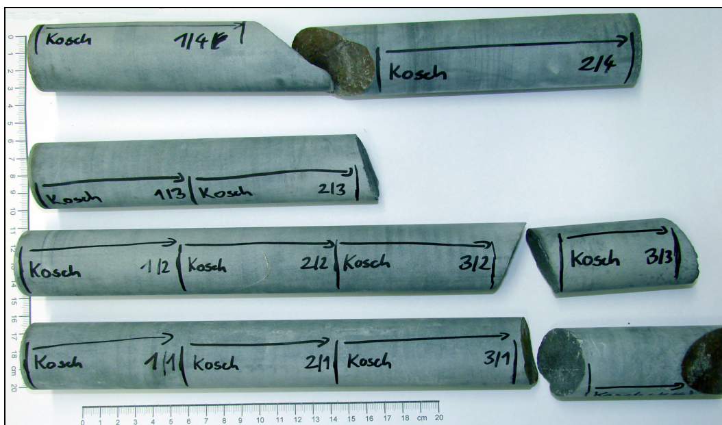
Bild 3.5: Prüfkörper des Tagebaues Koschenberg (Metagrauwacke)
