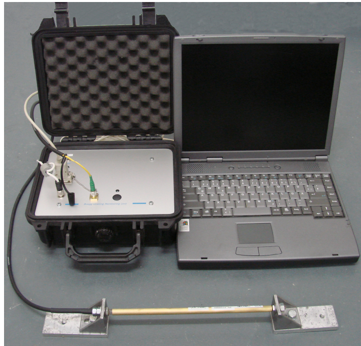
Bild 3.16: Kurzer dynamischer Dehnungssensor mit einem Messbereich bis 3000 ... 3500 \mu\text{m}/\text{m} (geeignet als Sensor hinter dem Bohrloch)
