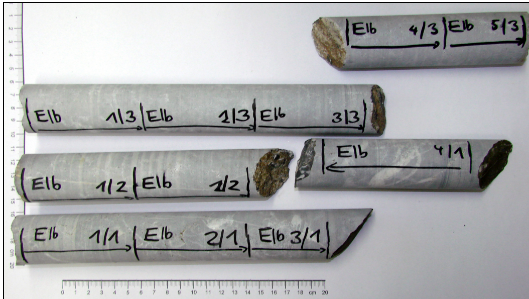
Bild 3.3: Prüfkörper des Tagebaues Elbingerode (Kalkstein)
