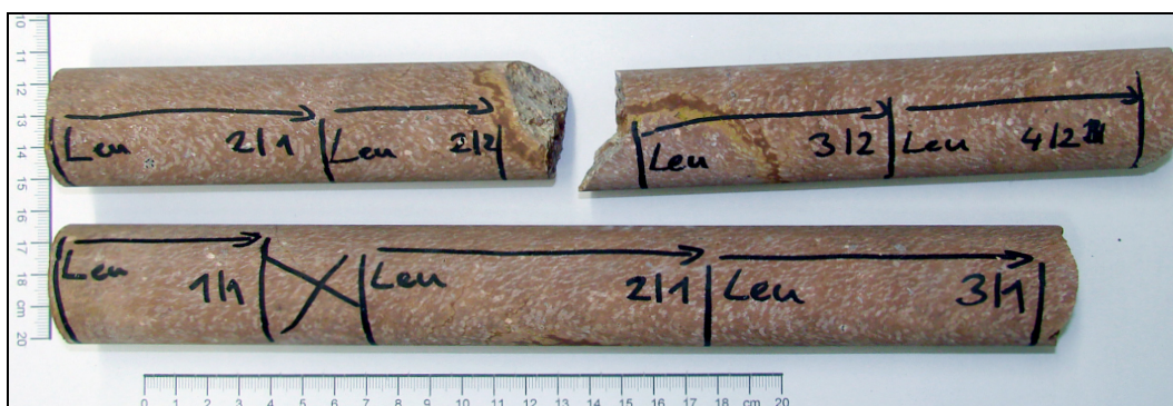
Bild 3.8a: Prüfkörper des Tagebaues Leukersdorf (Rhyolith, Rhyolith-Pyroklastite mit verschiedenen Korngrößen)
