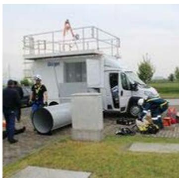
**Abbildung 1: mobile Trainingseinheit für Simulation eines Einsatzes im Kanal**
