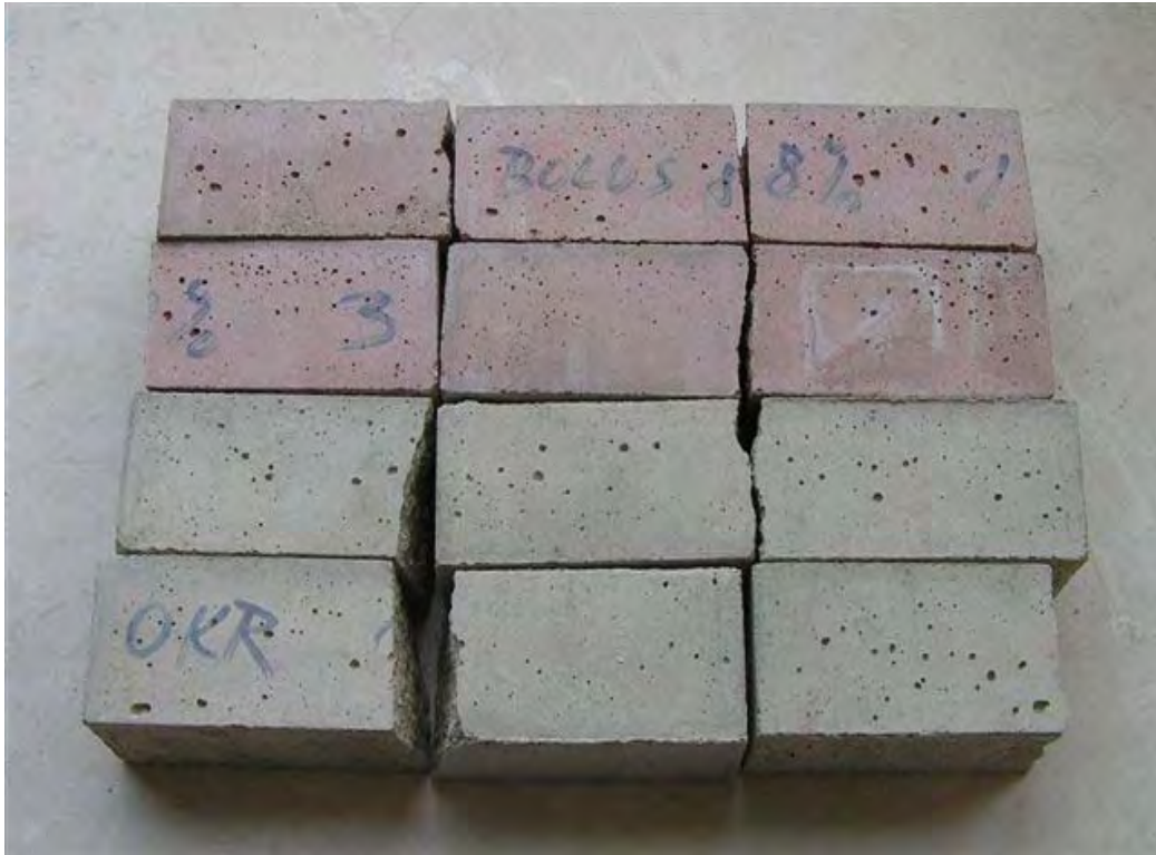
Abbildung 8-4 Betonprüfwürfel eingefärbt mit Bolus und Ocker
