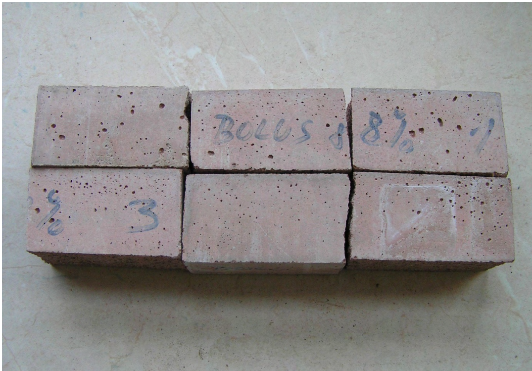
Abbildung 8-2 Beton-Testkörper eingefärbt mit 3 und 8 Gew.% Bolus
