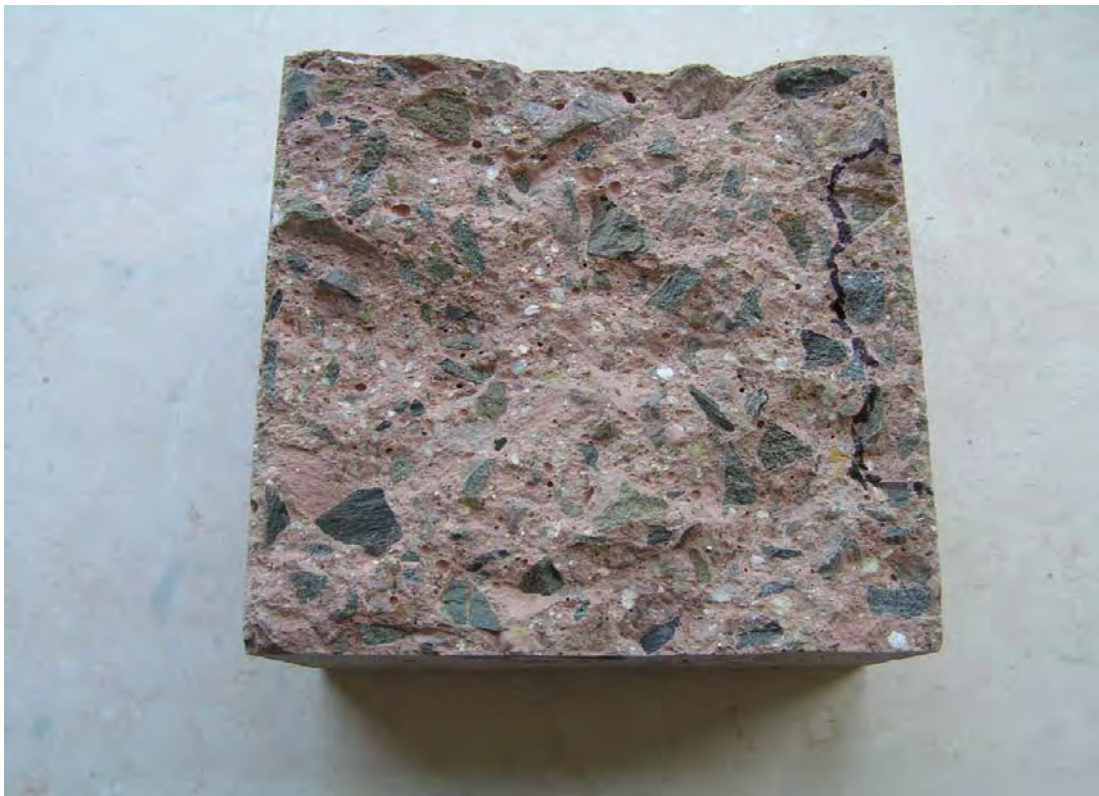
Abbildung 8-5 Zementgemisch mit 8 Gew.% Boluspigment
