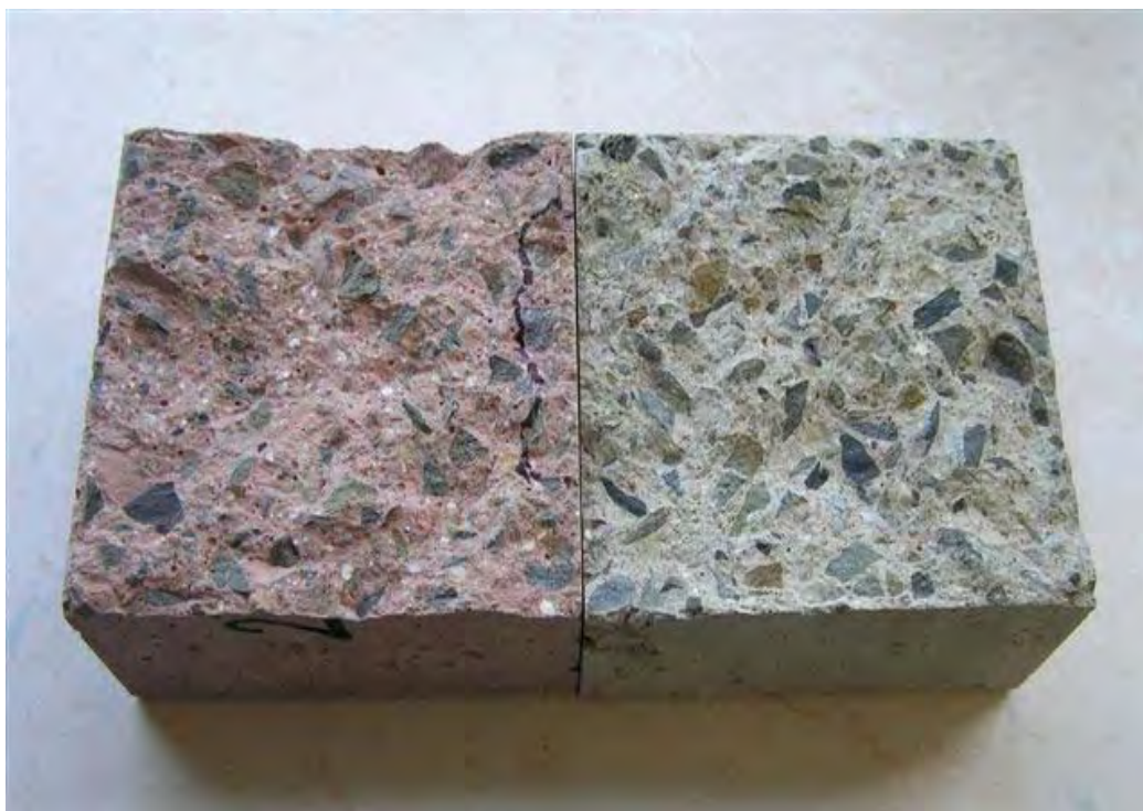
Abbildung 8-7 Zementprüfprismen eingefärbt mit Bolus und Ocker
