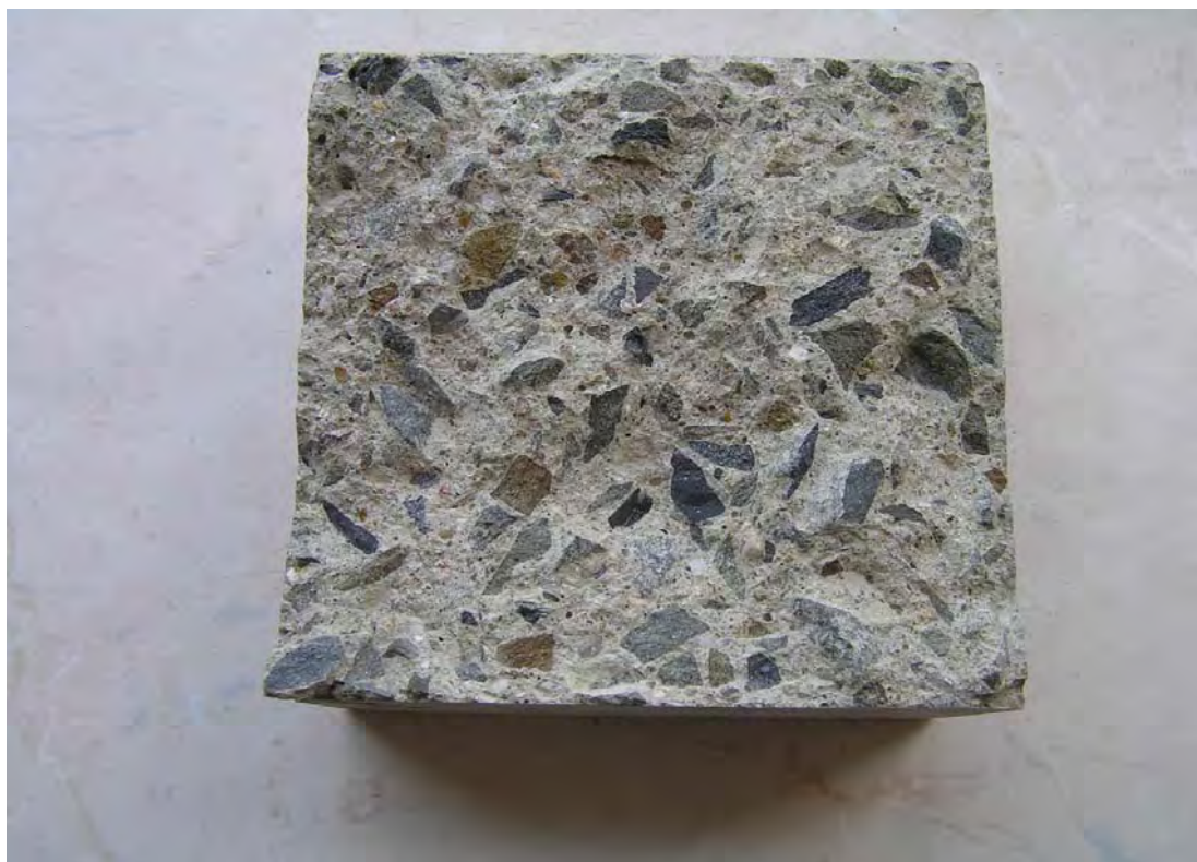
Abbildung 8-6 Zementgemisch mit 8 Gew.% Ocker
