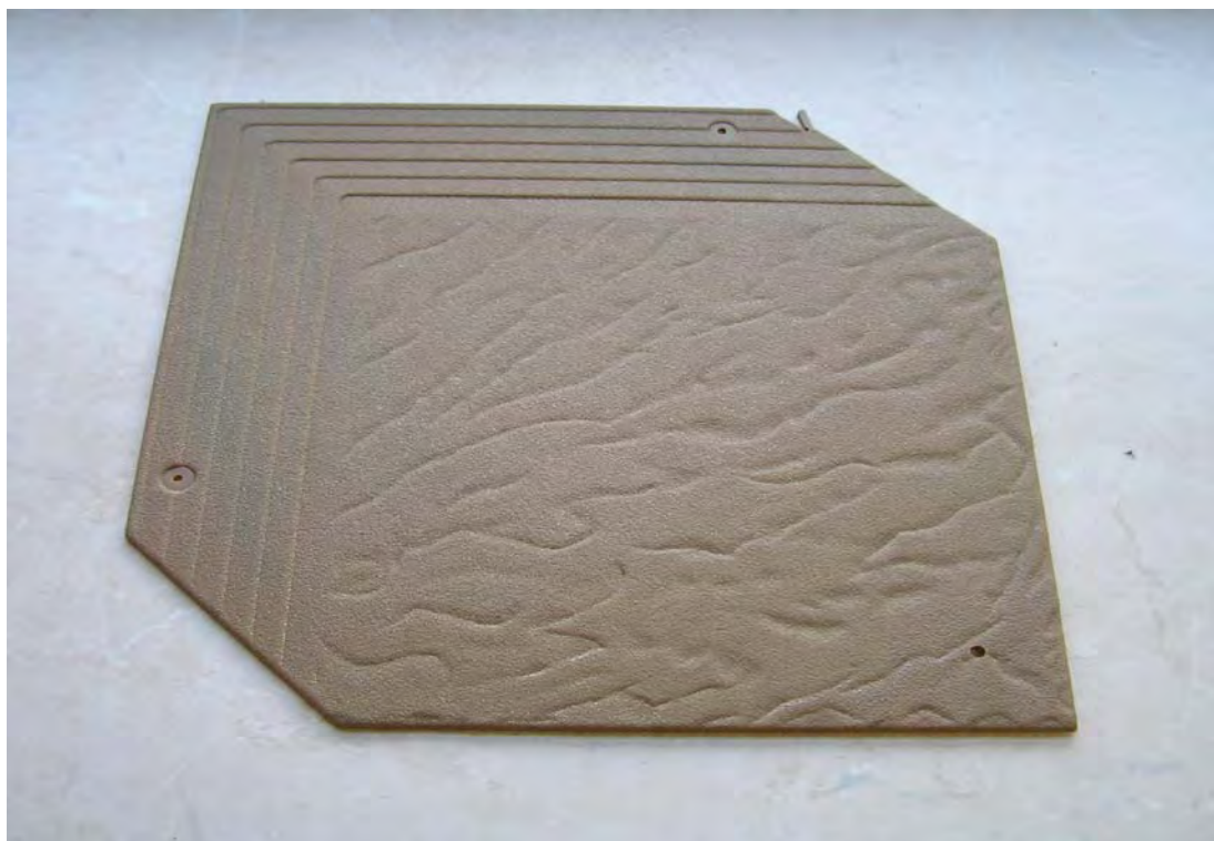
Abbildung 8-10 Kunststoffdachziegel eingefärbt mit 4 Gew. % Ocker
