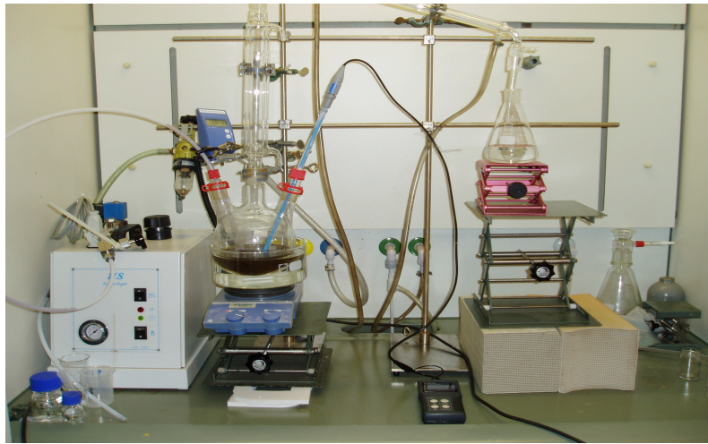
Abbildung 4-34: Laborversuchsanlage zur Ammoniakstrippung mit Luft und Dampf
