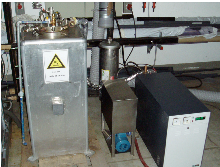
Abbildung 4-4: Technikums-Hydrolysereaktor mit Dampferzeuger
