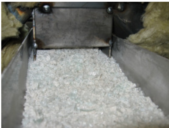
Bild 18 Materialabzug Versuchstauscher 1 (Material vorgetrocknet)
