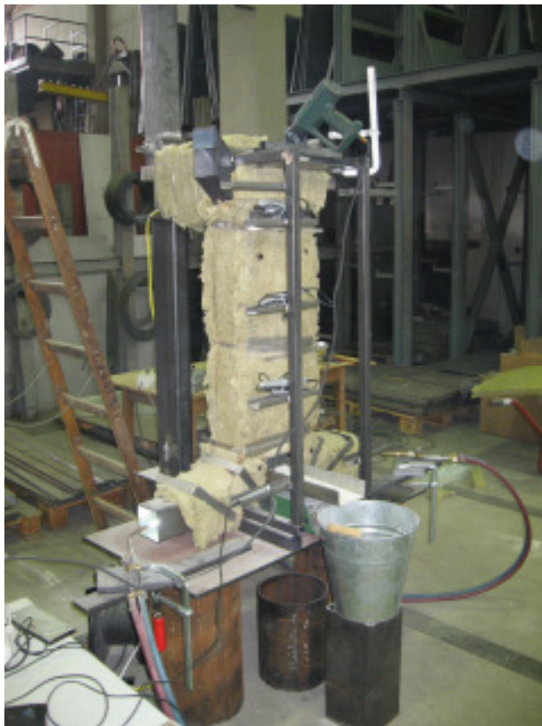
Bild 24 Versuchsanordnung des ersten Versuchstauschers
