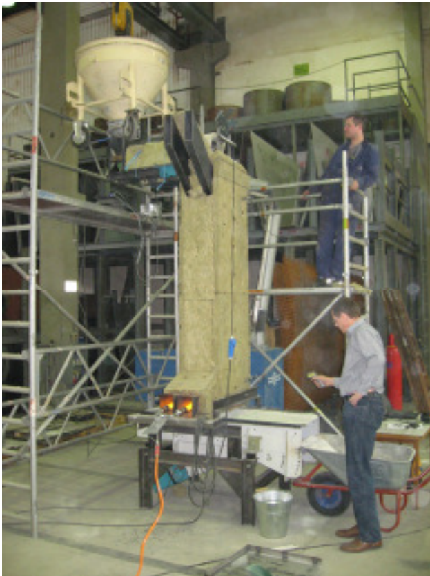
Bild 28 Versuchsaufbau des zweiten Testtauschers
