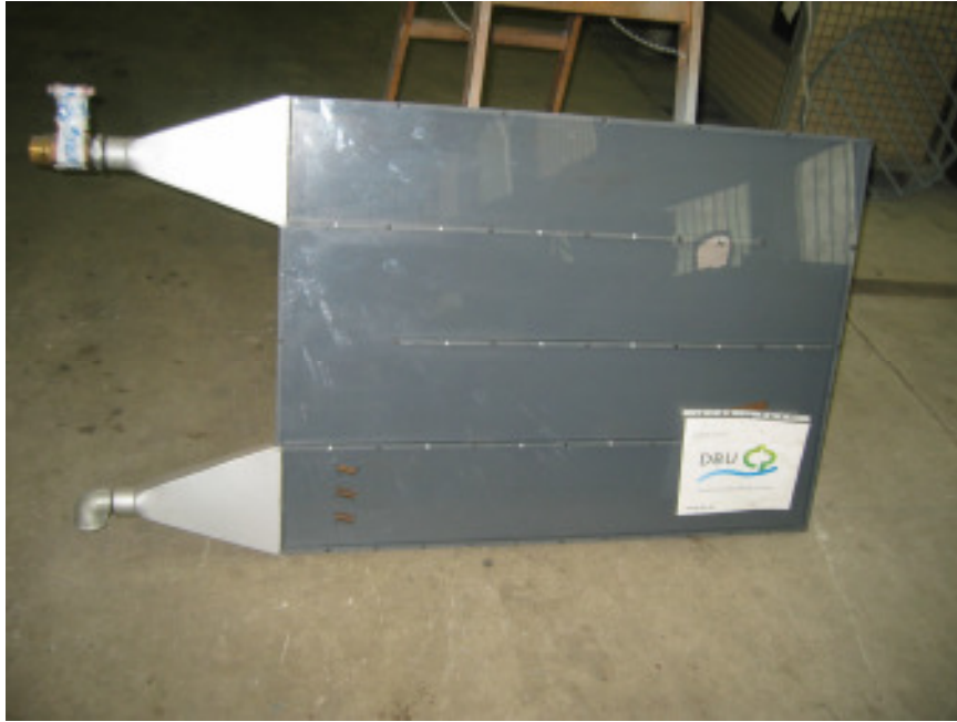
Bild 35 Modell eines Rauchgasschachtes für Strömungsversuche
