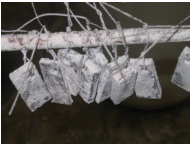
Bild 3 Stahlproben nach Korrosionstest in 300 °C
