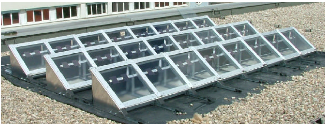
Abbildung 10: Für die Außenbewitterungsversuche aufgebauter Versuchsstand
