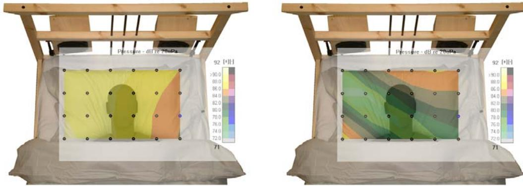
Bild 4: Primärfeld (links) und Ruhezone bei Anregung mit 100Hz (Punktabstand 10cm)
