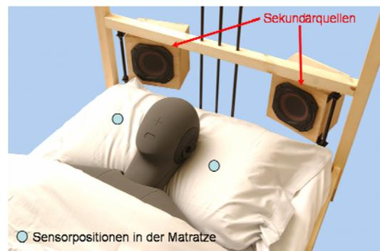
Abbildung 1: Prüfstand zur Untersuchung eines Gegenschallsystems zur aktiven Lärminderung in Schlafräumen.
