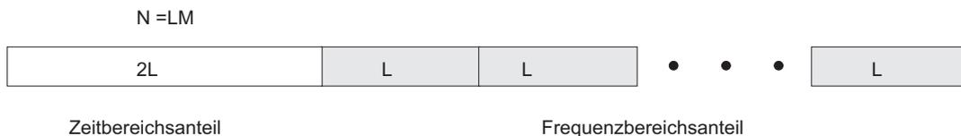
**Bild C.1:** Partitionierung einer Impulsantwort für die Latenzfreie Schnelle Faltung.
