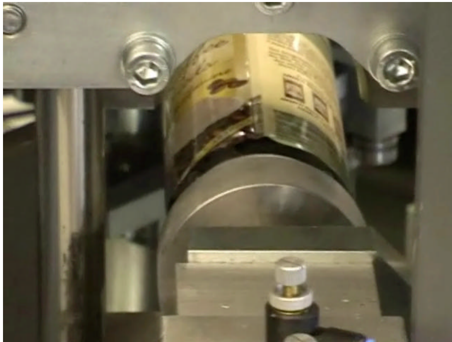
Abbildung 3: Detailaufnahme der Bodeneinsiegelung)
