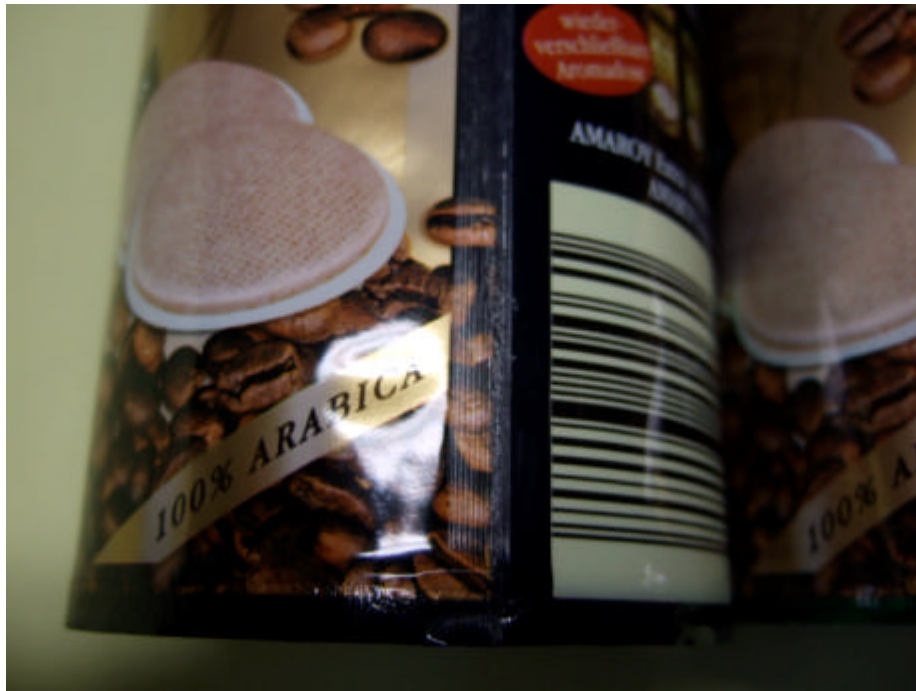
Abbildung 8: Detailaufnahme der seitlichen Siegelnaht
