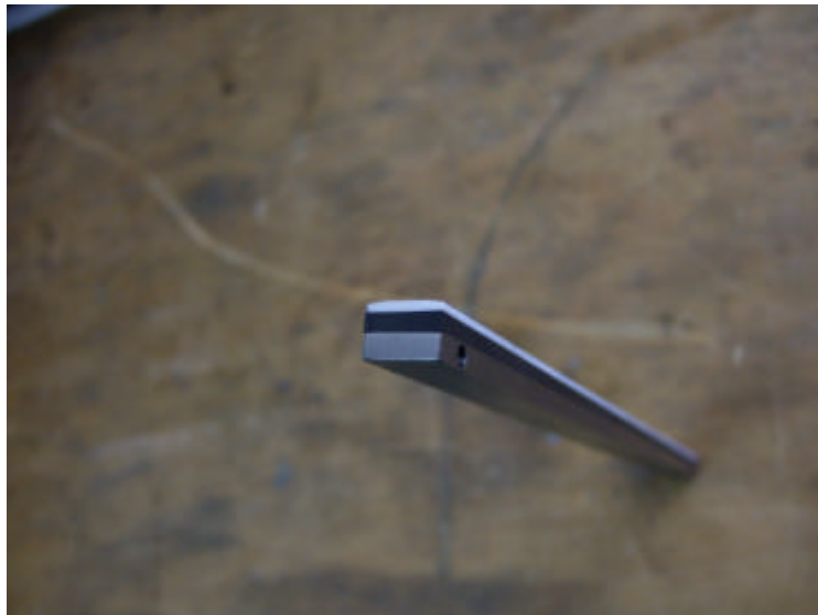
Abbildung 12: Beschichteter Siegelbutton zur Verhinderung des Anhaftens des Folienmaterials
