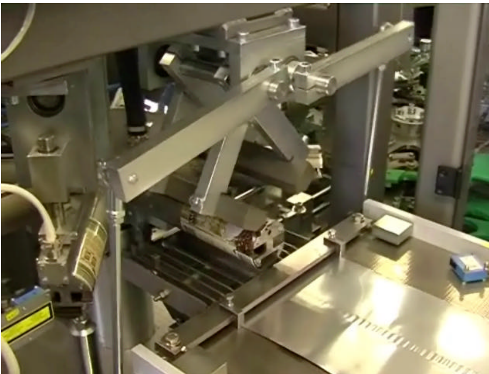
Abbildung 1: Herstellung des Grundkörpers der Foliendose
