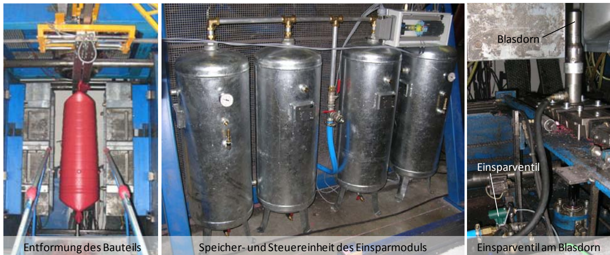
Abbildung 21: Umgerüstete Großblasformanlage der ESDA Kunststofftechnik
