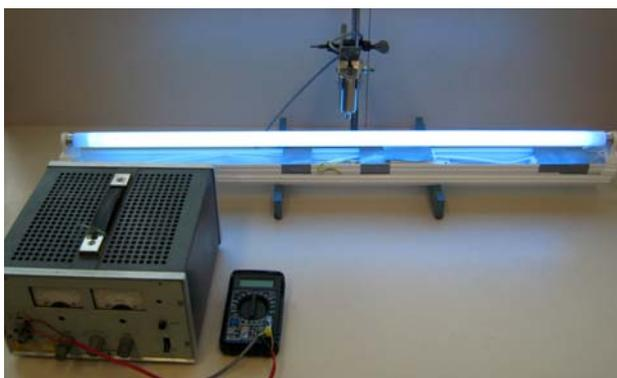
Abb. 2 Messanordnung für UVA-Transmission
