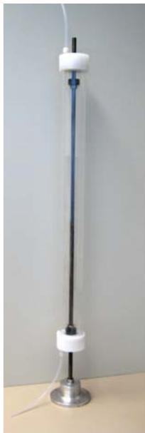
Abb.1 Beschichtungsapparatur für Borosilikatglasrohre mit einer Länge von 74 cm
