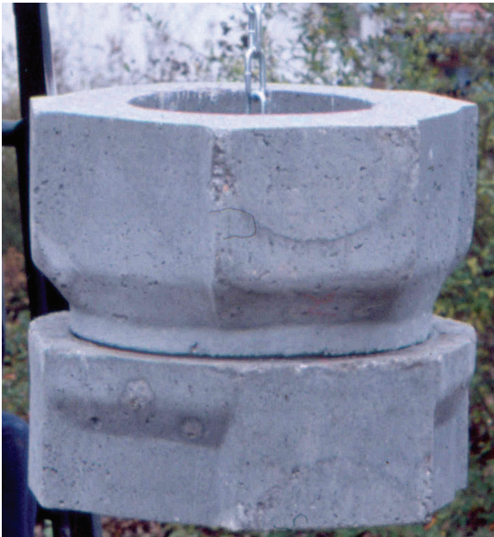
Abb. 1: Aus Spitzende (oben) und Muffe (unten) zusammengesetzte Rohrverbindung
