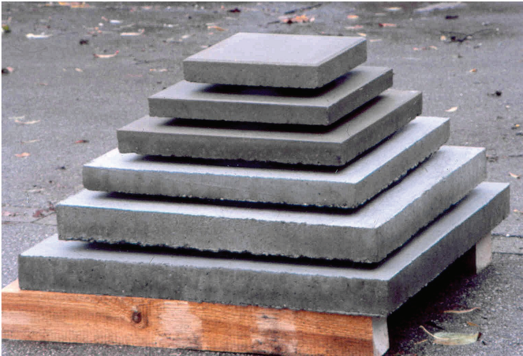
Abb. 11: Zu einem Stapel zusammengefasste Betonplatten mit dazwischen liegenden Bitumenringen (ohne Verschraubung)
