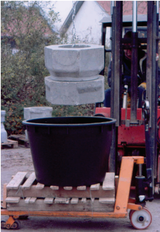
Abb. 4: Einbau einer Rohrverbindung in ein Versuchsgefäß
