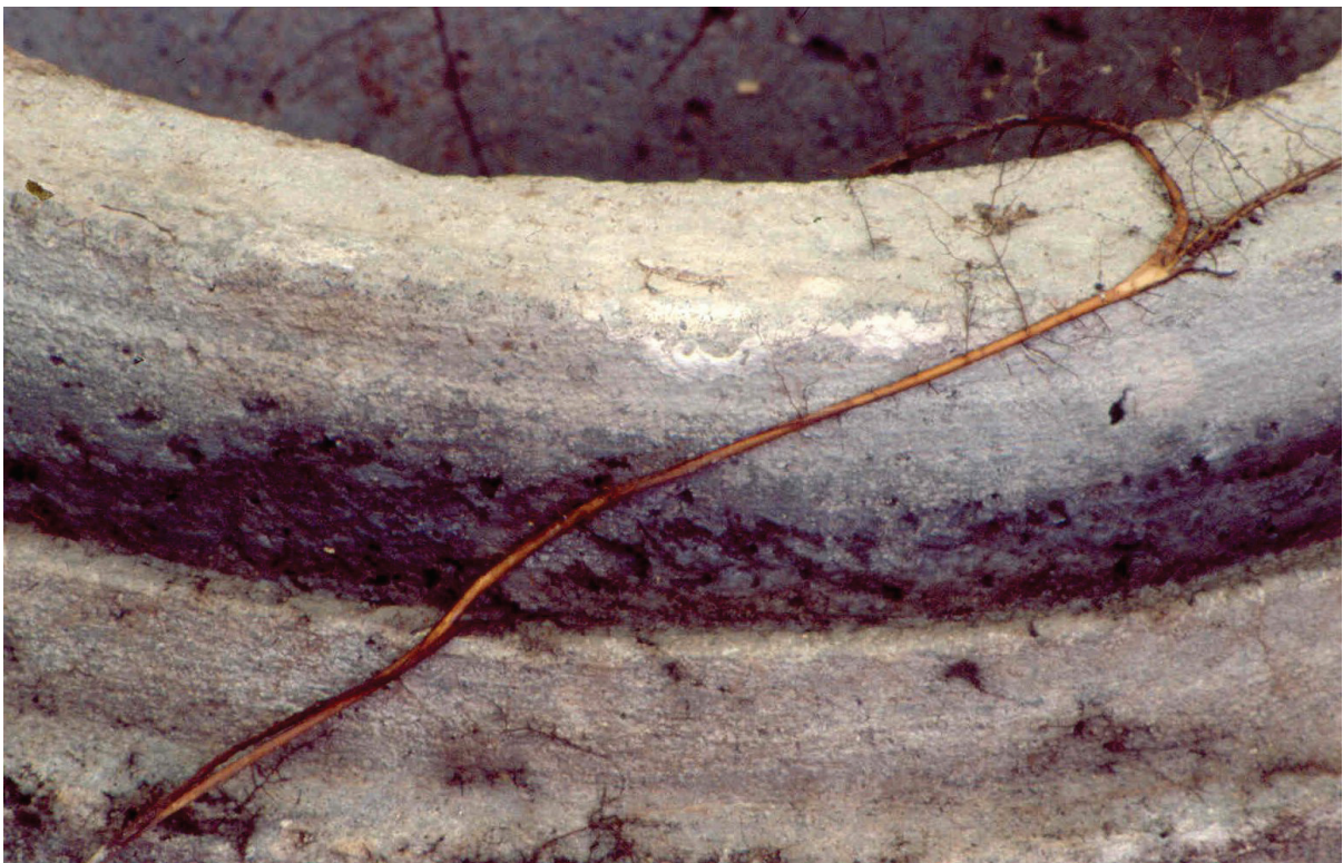
Abb. 80: Durch eine SBR-Dichtung gedrungene Wurzel von Ficus benjamina (Detail nach dem Entfernen der Dichtung)
