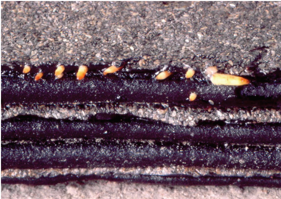
Abb. 21: Wurzeldurchdringungen von Pyracantha coccinea (Ring 5)
