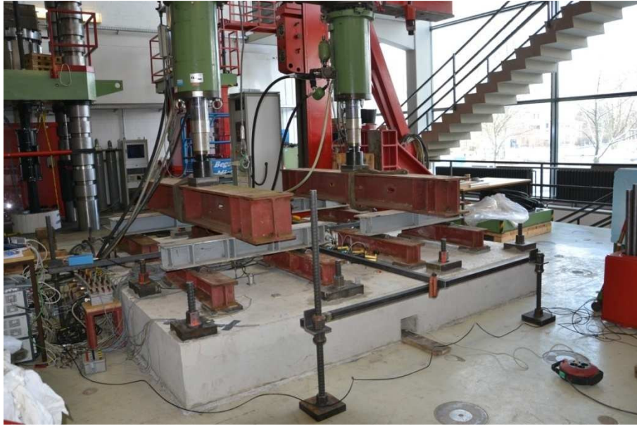
Abb. 47: Stahlbetonplatte mit mehrstufiger Belastungsvorrichtung
