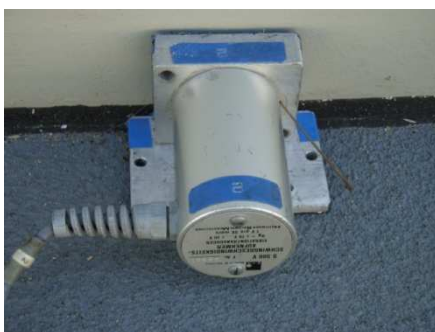
Abb. 11: links – Schwinggeschwindigkeitsaufnehmer, rechts – Funktionsprinzip
