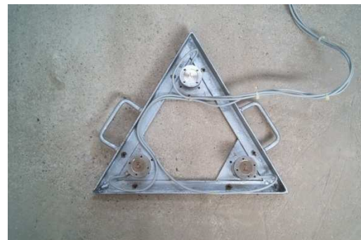
Abb. 14: Rahmen der Impulseinleitungsplatte: links – Vorderseite, rechts – Rückseite mit Kraftaufnehmern
