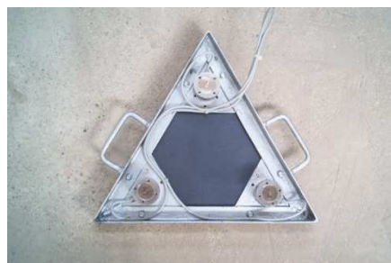
Abb. 15: Unterkonstruktion der Impulseinleitungsplatte mit Stahlauflage und Kraftaufnehmern
