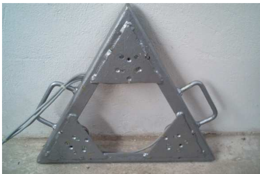
Abb. 14: Rahmen der Impulseinleitungsplatte: links – Vorderseite, rechts – Rückseite mit Kraftaufnehmern
