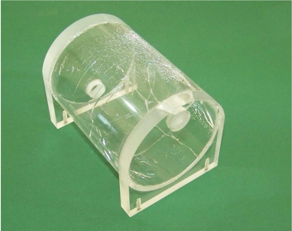
Abbildung A.2: Risse im Ausgleichsbehälter Die Kombination aus SES36 und Plexiglas führt unweigerlich zu Spannungsrissen.
