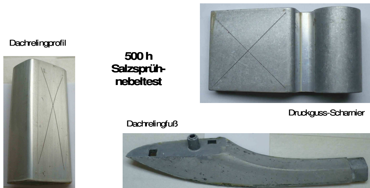
Abbildung 23: verschiedene Alu-Realteile nach 500h Salzsprühtest
