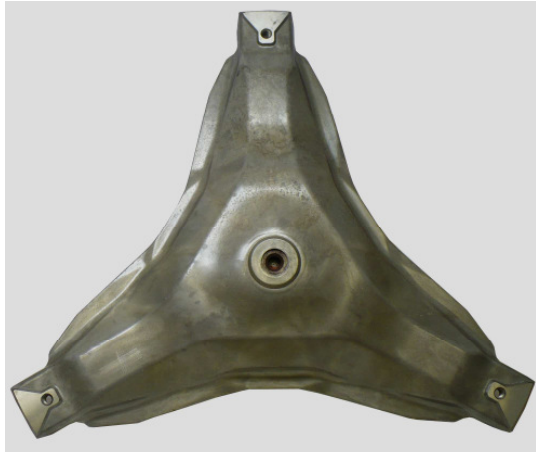
Abbildung 24: Waschmaschinenbauteil nach 20 Tagen Wechselklima, Gt 0
