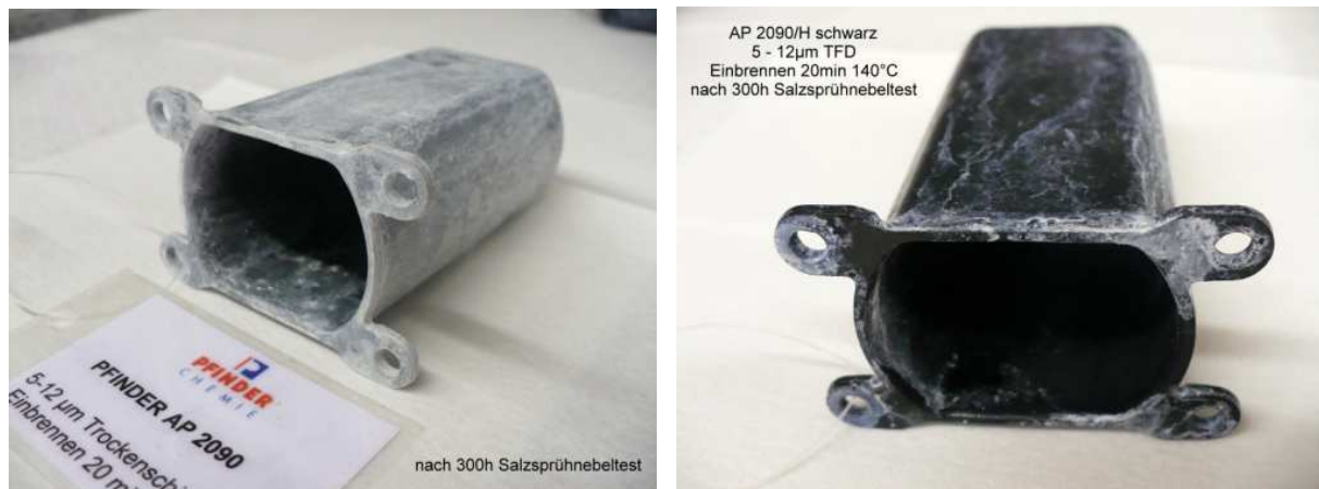
Abbildung 25: spritzlackierte Scheibenwischermotorgehäuse Zn/Fe-Mischsubstrat nach 300h Salzprühtest
