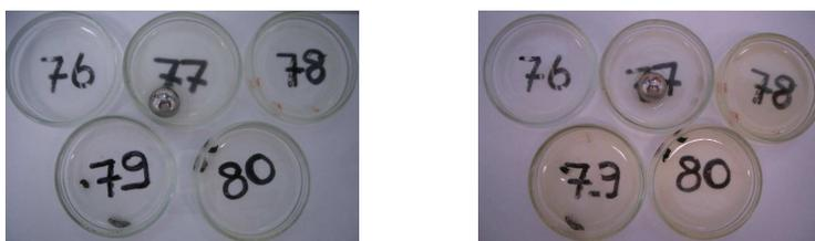
Abbildung 30: Korrosionsverhalten MMIM Me<sub>2</sub>PO<sub>4</sub> (additiviert mit ionischen Additiv) nach 24h und 100h
