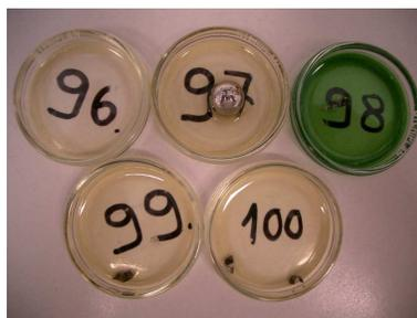
Abbildung 29: Korrosionsverhalten MMIM Me<sub>2</sub>PO<sub>4</sub> (unadditiviert) nach 24h
