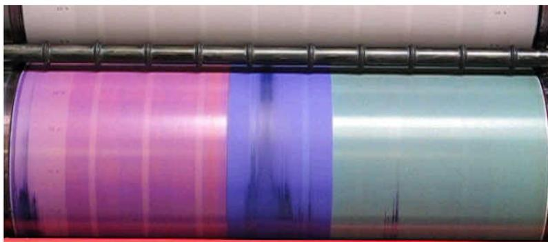
Bild 8: Reinigungsergebnis eines dreizonalen Drucktuches, links und rechts Versuchsbeschichtungen, im Mittenbereich die Standardoberfläche des unbeschichteten Drucktuches
