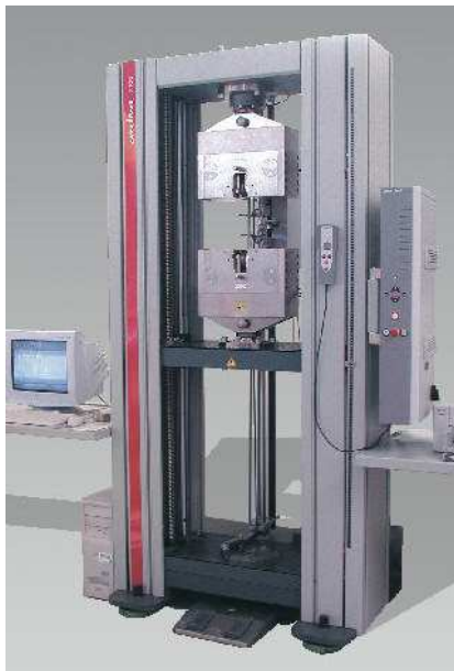
Abb. 9: Zugprüfmaschine von Zwick [10]
