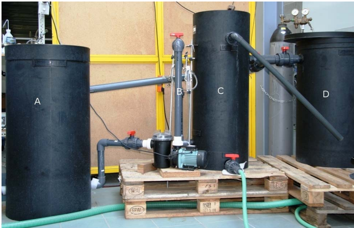
Abbildung 14. Zerschäumungsapparatur im halbtechnischen Maßstab. A: Vorlagebehälter, B: Gasanschluss mit eingebauter Fritte, C: Zerschäumungssäule, D: Behälter für bereits zerschäumte Flüssigkeit. Eine Rückführung der zerschäumten Flüssigkeit in den Vorlagebehälter für ein kontinuierliches Verfahren ist möglich. (Henderson Plastics Ltd., Dereham, Great Brittan)
