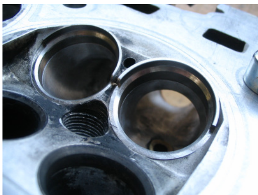
Bild 8: Maskierung mit 3mm Höhe, in den Sitzring integriert (nicht volllastfest)
