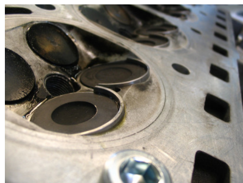
Bild 8: Maskierung mit 3mm Höhe, in den Sitzring integriert (nicht volllastfest)
