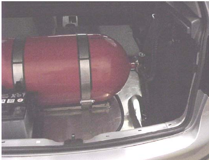
Bild 30: Nachgerüsteter CNG Gastank im Golf V Versuchsfahrzeug
