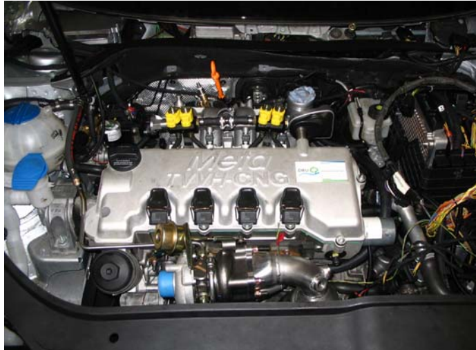
Bild 29: 1.4L TVVH-CNG Motor im Golf V Versuchsfahrzeug
