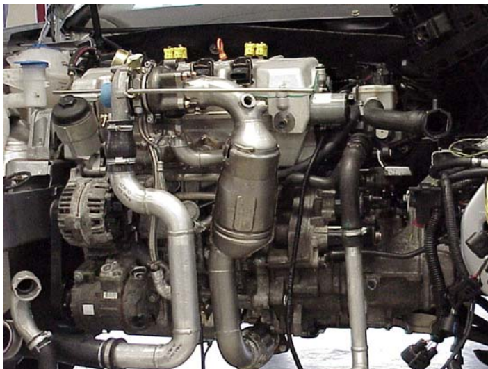
Bild 28: 1.4L TVVH-CNG Motor im Golf V Versuchsfahrzeug, Ansicht auf Krümmer, Turbolader und Katalysator
