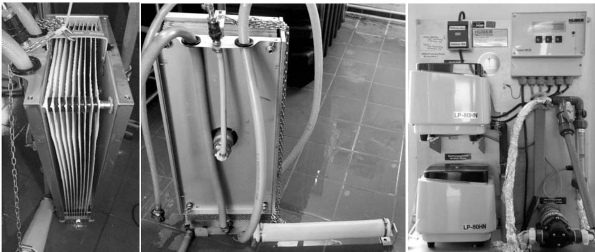
**Abbildung 4.7: Verwendetes Membranmodul (links: Plattenmembran; Mitte: Nachrüstsatz mit Rohrbelüfter; rechts: Steuerung, Kompressoren, Permeatpumpe)**
