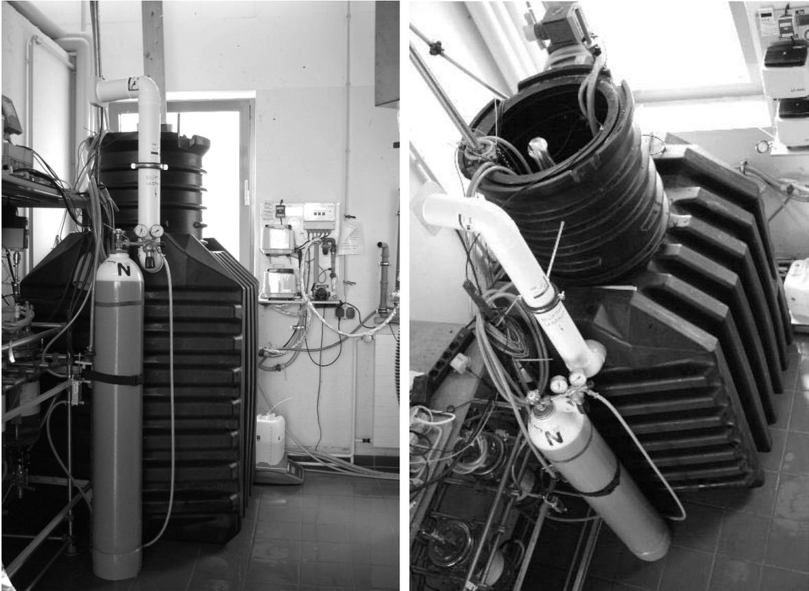
**Abbildung 4.11: Membranbelebungsanlage während der Versuche zum Abbau von BDF-Abwasser**
