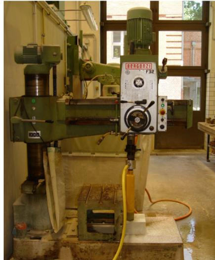
b) Marmorblock in der Bohrmaschine
