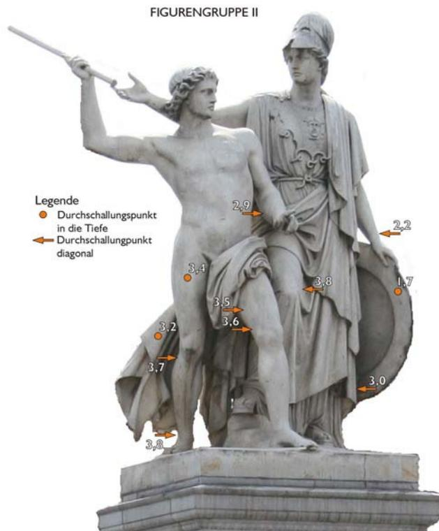
Abb. 4: Ultraschall-Einzelmessungen an der Figurengruppe II (Zahlenwerte in km/s).
