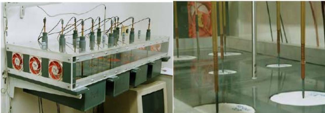
Abbildung 2.2.8: Messapparatur, entwickelt um unter definierten Randbedingungen den Trocknungsverlauf zu ermitteln. Oben: Schemadiagramm der Messeinrichtung, unten links: photographische Ansicht der Messeinrichtung, unten rechts: photographische Ansicht der installierten Sensoren.
