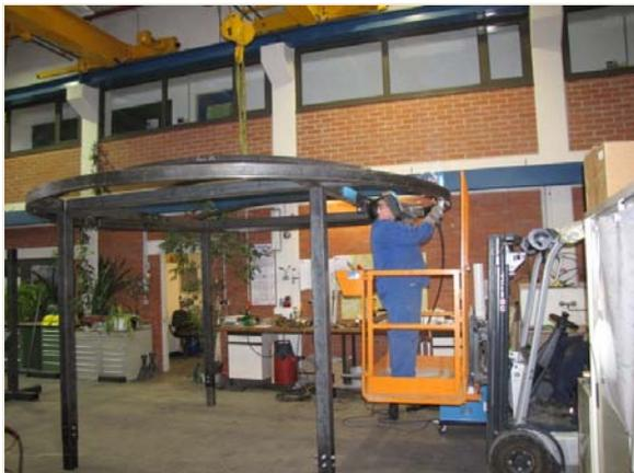
**Abbildung 22:** Schweißen des oberen Segments
