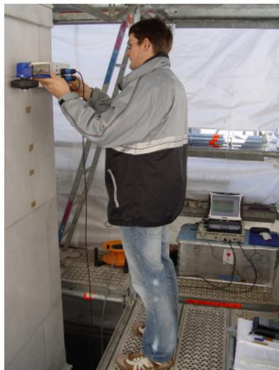
**Abbildung 30:** Zerstörungsfreie Untersuchung der Postamente mit RADAR
