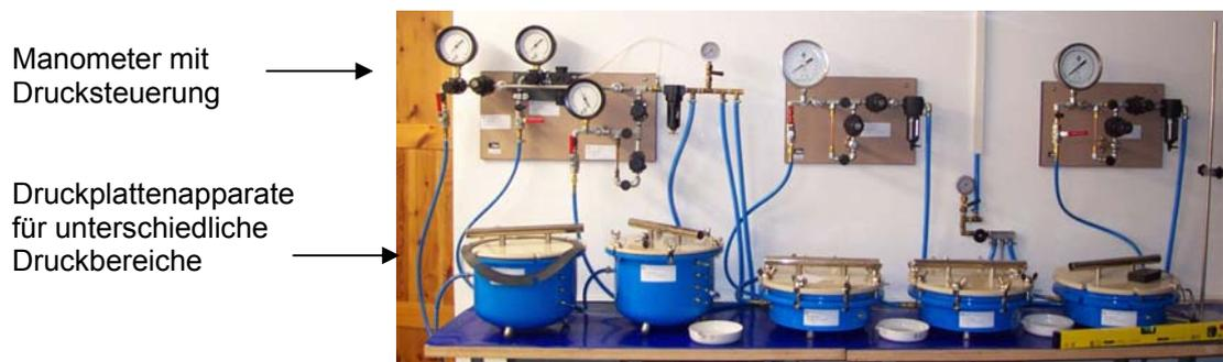
Abbildung 2.5: Druckplattenapparatur zur Bestimmung der Feuchtespeicherung im überhygroskopischen Bereich zwischen 3 to 1500 kPa.
