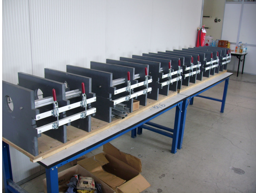
Abbildung 46: Form zur Fertigung der Primärspiegel
