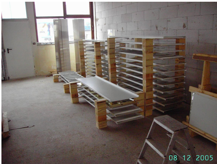
Abbildung 22: vorgefertigte Spiegel in der PSE Werkstatt
