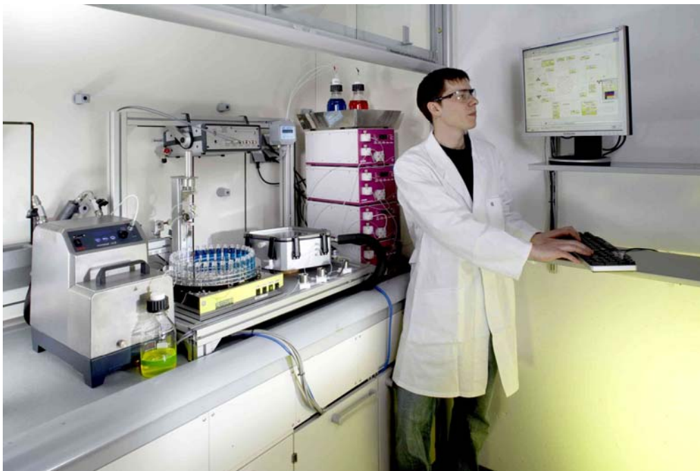
Abb. 10: Automatisiertes Mikroreaktionssystem »FAMOSflexible« für Screening-Anwendungen (Nähere Informationen auch unter www.mikroreaktionstechnik.info )
