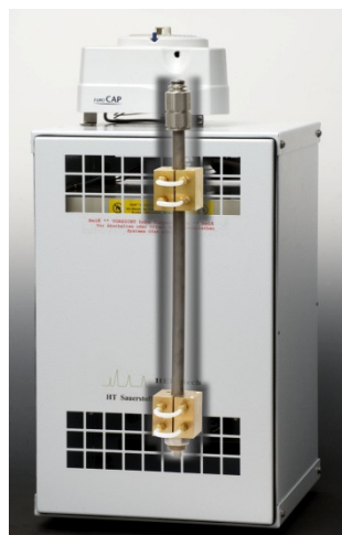
Abbildung 3: Siliciumcarbidrohr im Hochtemperaturofen mit Kühlaggregaten (Reaktionsrohr innen verbaut).
