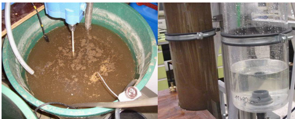
Abbildung 11: Konditioniertes Rohwasser, Filtrations- und Permeatsammelbehälter der Versuchsanlage 1
