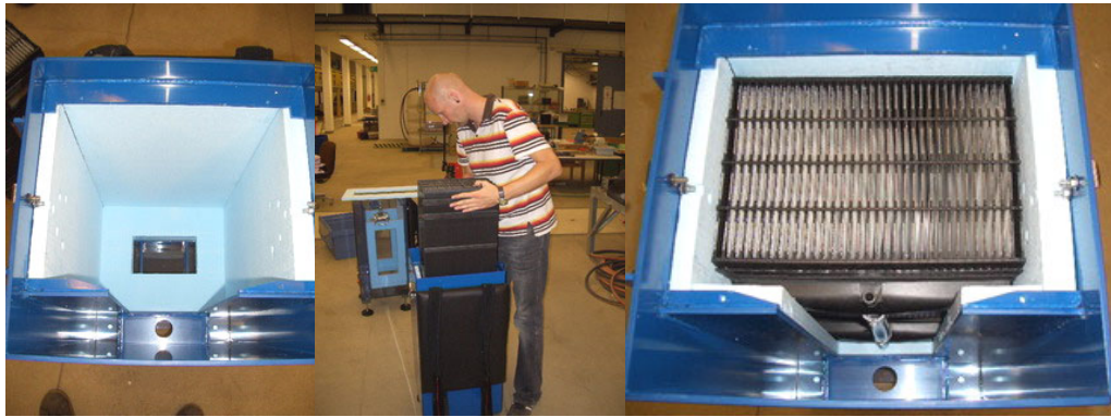
Abbildung 36: Einsetzen von Membrandämpfung und Membranmodul
