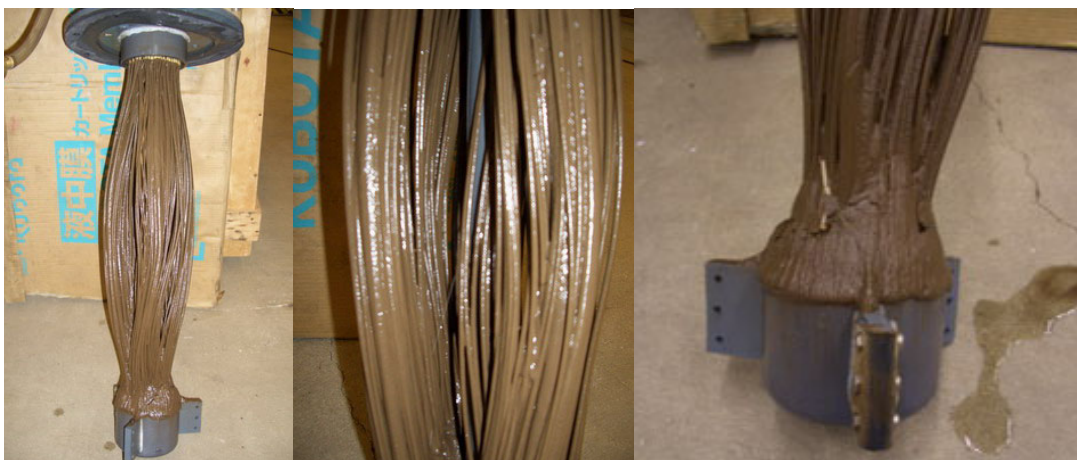
Abbildung 13: Membran nach 6 Tagen Versuchsbetrieb, Versuchsstand 1
