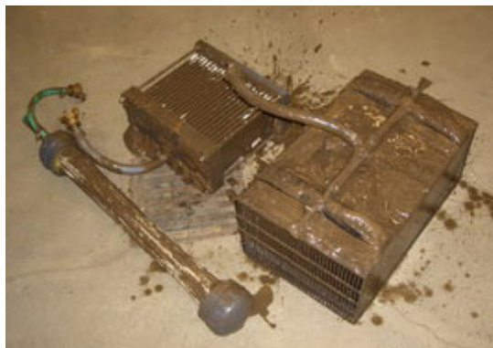
Abbildung 20: Membranen nach 3,5 Tagen Versuchsbetrieb, Versuchsstand 2
