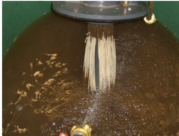
Abbildung 14: Membranreinigung nach 6 Tagen Versuchsbetrieb, Versuchsstand 1
