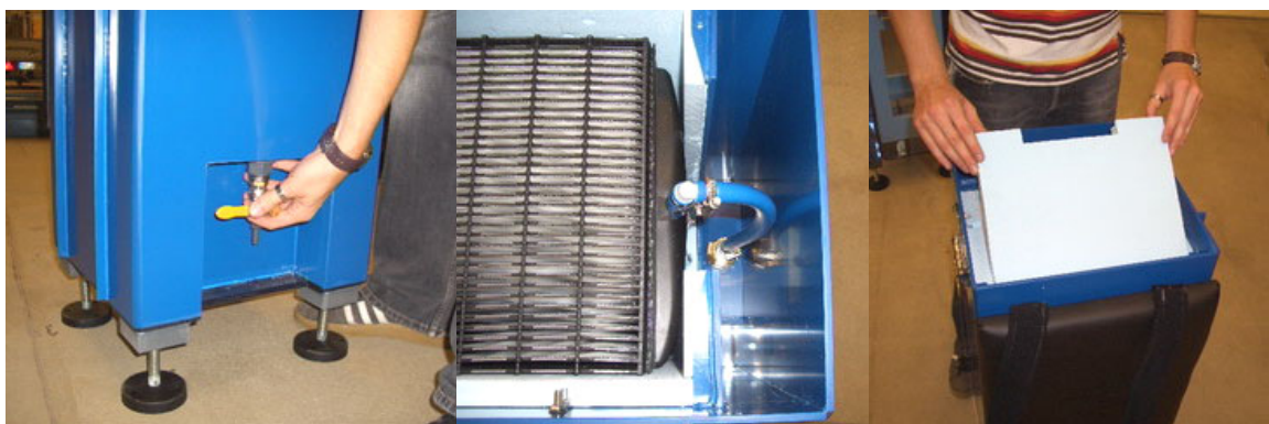
Abbildung 37: Einbau Permeathahn, Permeatleitung und obere Membrandämpfung
