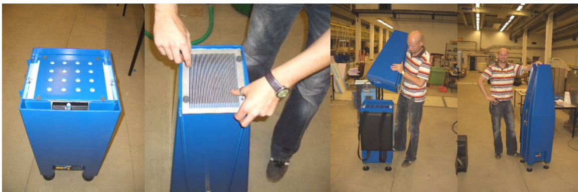
Abbildung 38: Einbau Membranabdeckung, Vorsieb, Aufsatz Gehäuseoberteil
