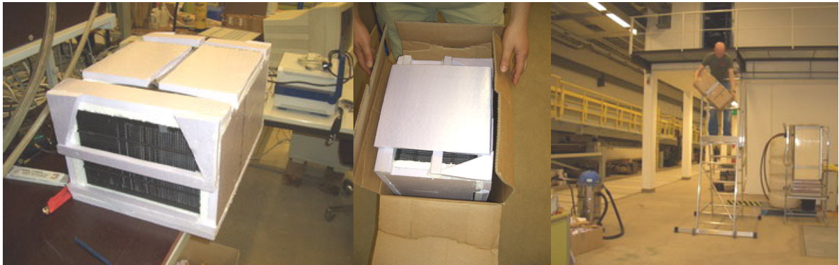
Abbildung 25: gedämmte Membran, Fallversuch aus 2 m Höhe
