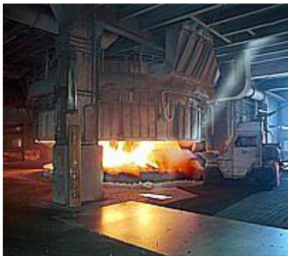
Abbildung 2.1: Schematische Darstellung einer Produktionsstätte für metallurgisches (MG-)Silizium
