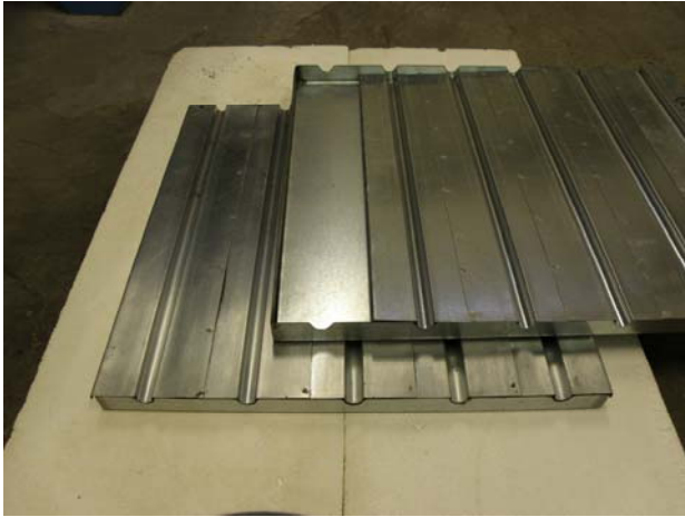
Abbildung 13 Aufbau der Probekörper
