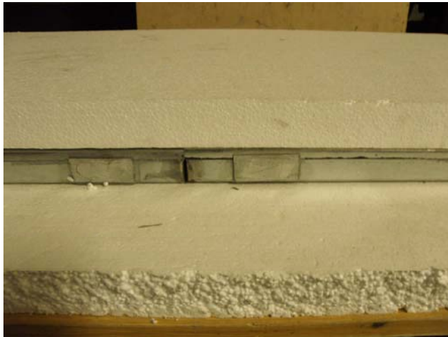
Abbildung 17 Wärmedämmung ober- und unterhalb Probekörper
