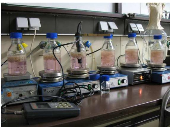
**Abb. 7.1:** Versuchsaufbau eines Sauerstoff-Aktivitätstests im 22°Raum. In den Flaschen sorgen unterschiedlich große Rührstäbe und unterschiedliche Rührgeschwindigkeiten für zwei unterschiedliche Sauerstoffverhältnisse.
