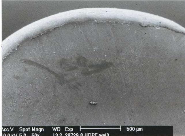
**Abb. 4.14: REM-Aufnahme eines Granulatpellets aus weißem HDPE. Balken = 500 µm.**
