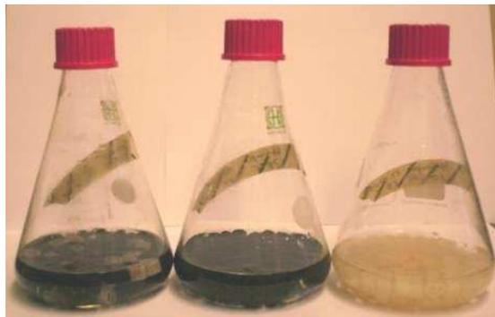
**Abb. 9.1: Gasdichte Kolben mit Biofiltermaterial**
