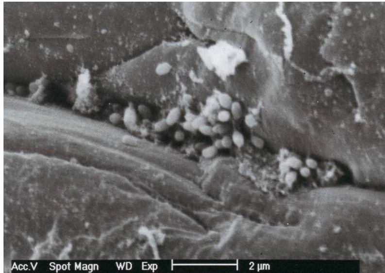
**Abb. 4.11: REM-Aufnahme von Zellen in einer Vertiefung auf einem Granulatpellet aus recyceltem HDPE. Balken = 2 µm.**
