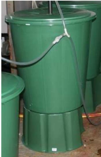
Abb. 3: Biofiltertonnen - Versuchskreislauf Strande
