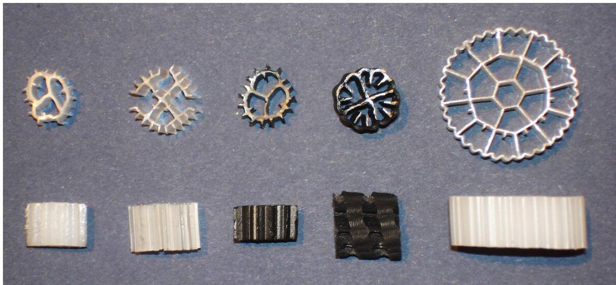
Abb. 6: Verwendete Biocarrier für Vergleichstests. Von links nach rechts die ausgewählten BC Nr. E1-E5.
