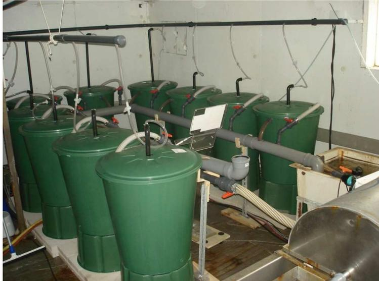
Abb. 4: Gesamtansicht der 10 Biofiltertonnen des Versuchskreislaufs Strande
