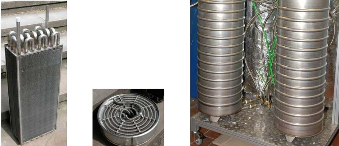
**Abbildung 2** Adsorber (links), Verdampfer (mitte) und Zeolithspeichermodule (rechts)
