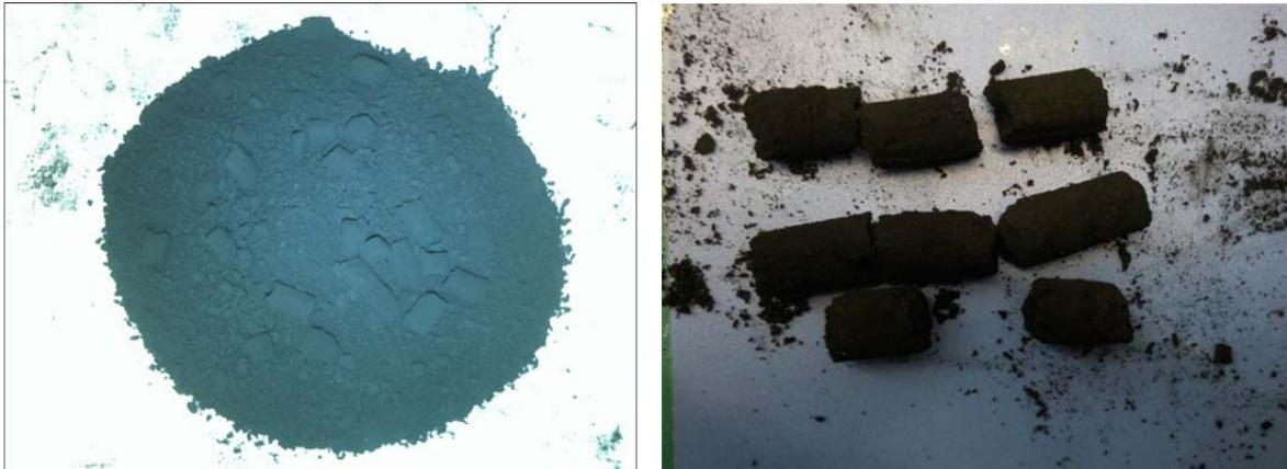
**Abbildung 15** Ruß aus dem Wärmetauscher
