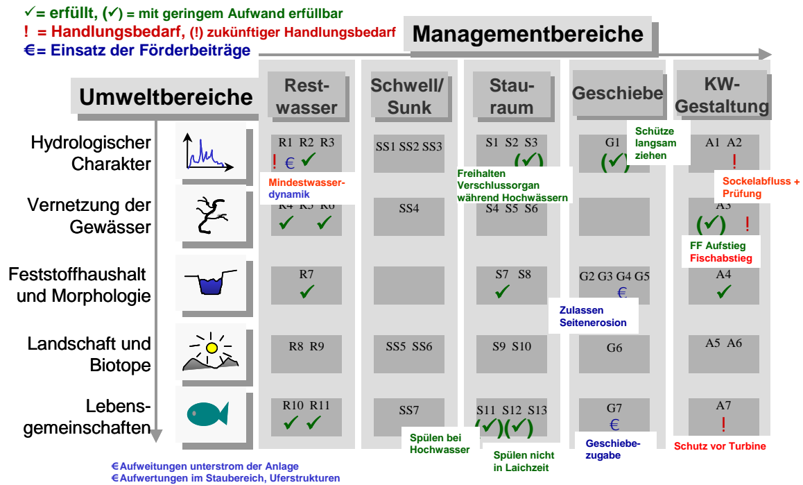
Abb. 9 Zusammenfassende Bewertung für die WKA Rotenfels, Murg; Relevanzmatrix mit irrelevanten (leer), und erfüllten Anforderungen (✓), sowie Forderungen nach Verbesserungen (!) und Einsatzbereichen für die ÖFB (€)
