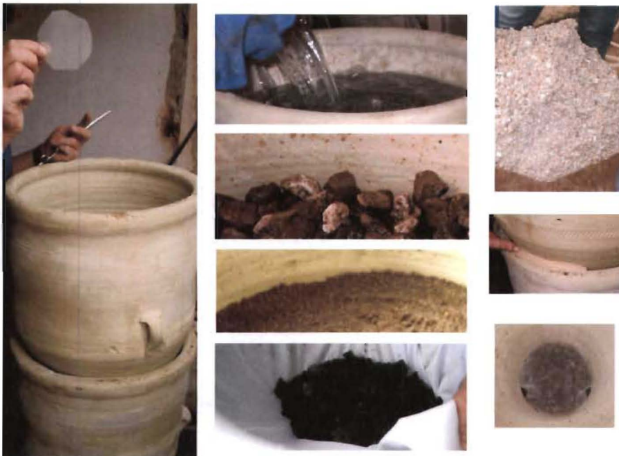
Abb. 5: Aufbau, Material und Benutzung des Sand-Kohle-Filters (Filter 2)
