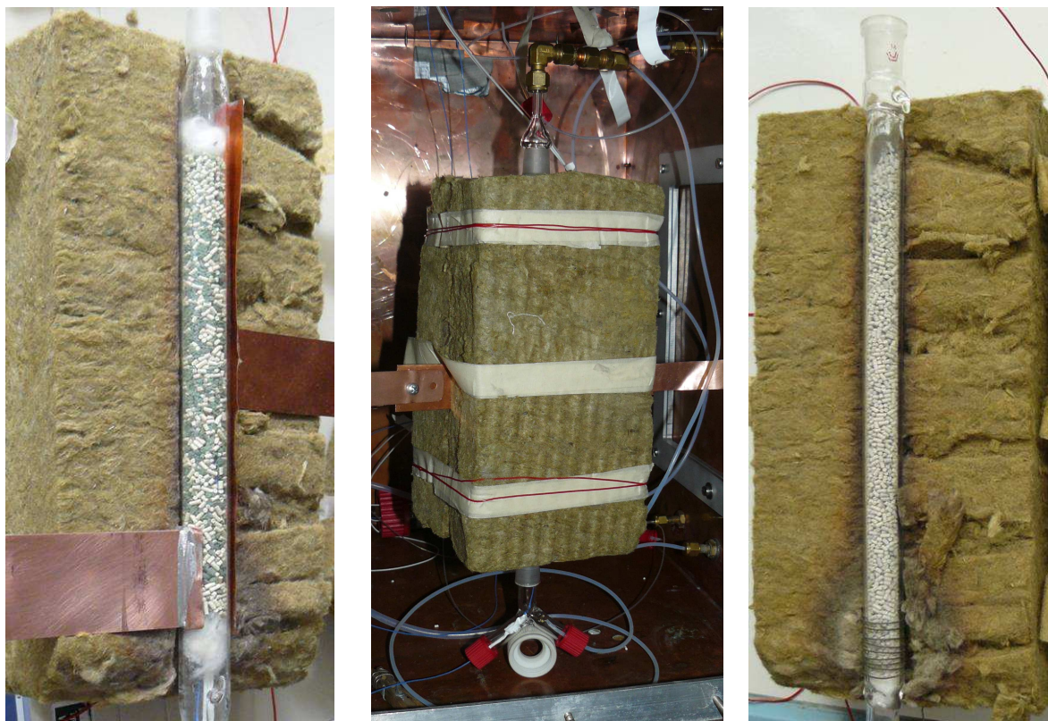
Abbildung 1 Isoliertes dünnes Probenrohr. Links : zur selektiven dielektrischen Erwärmung gefüllt mit einem Mischschüttbett bestehend aus CrTiCu-Katalysator und Zeolith HiSiv1000 im Masseverhältnis 1:1; Mitte : in Laboranlage eingebautes Probenrohr inklusive Isolierung; rechts : während eines Referenzexperiments mit selektiver ohmscher Erwärmung, gefüllt mit dem Zeolith HiSiv1000/Pt (0,5 Ma.-% Pt-Gehalt).
