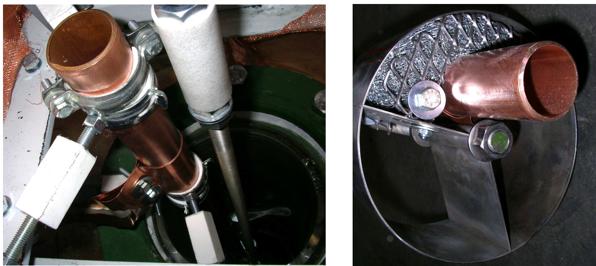
Abbildung 9 Nach Vorversuchen ermitteltes Design der Kontaktierung der heißen Elektrode. Diese ist entlang einer fest installierten Kupferstange verschiebbar, wobei der Abgriff durch einen Gleitkontakt realisiert wird.
