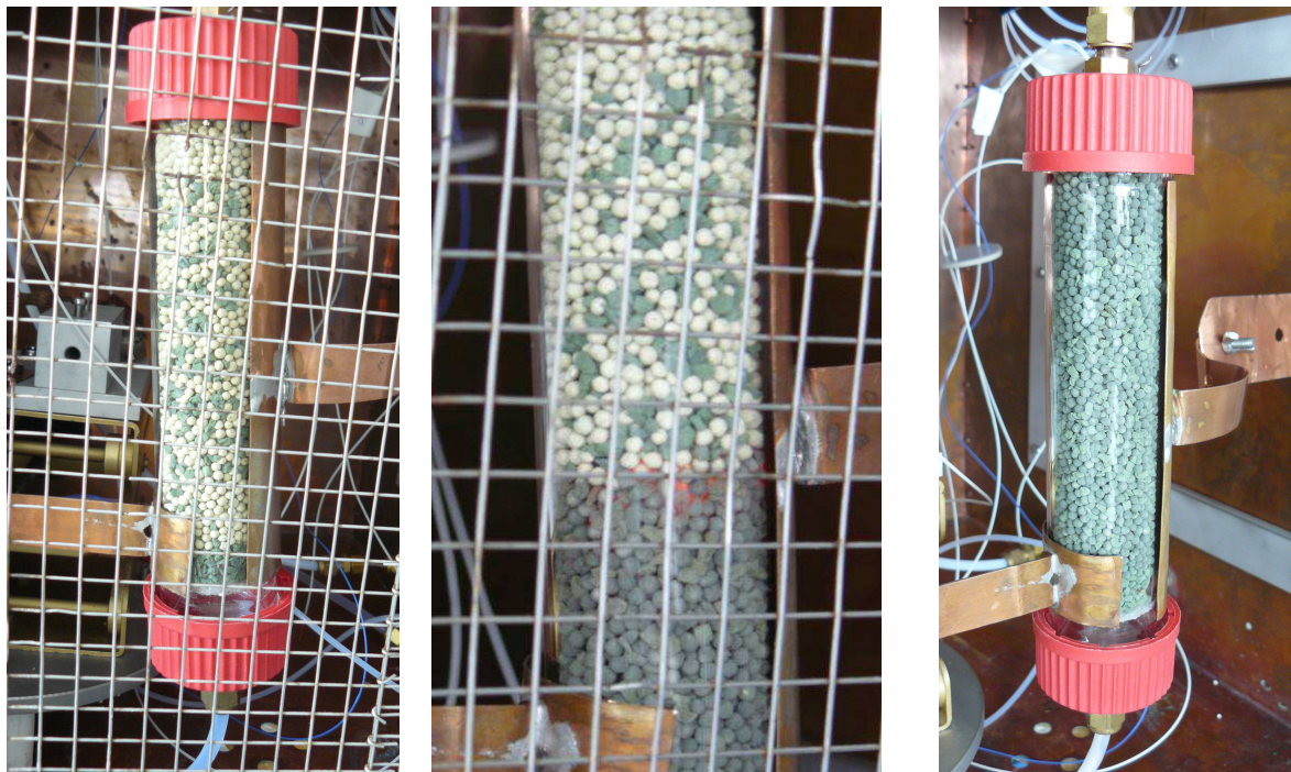
Abbildung 23 Fotos des in einen Laborreaktor eingebauten CrTiCu/UK8-Schüttbetts, links : vor, Mitte : während und rechts : nach der ersten Regeneration. Während der Regeneration ist es so heiß, dass das Schüttbett glüht.
