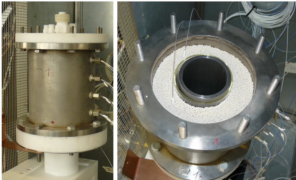
Abbildung 3 Schema und Fotos des Koaxialreaktors mit faseroptischen Temperatursensoren.
