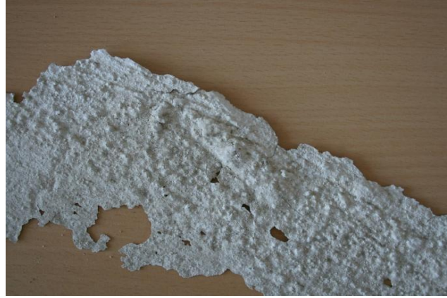
Die Kalkschlämmschicht konnte großflächig abgezogen werden, Zusatz von Polyvinylacetat wurde nachgewiesen
