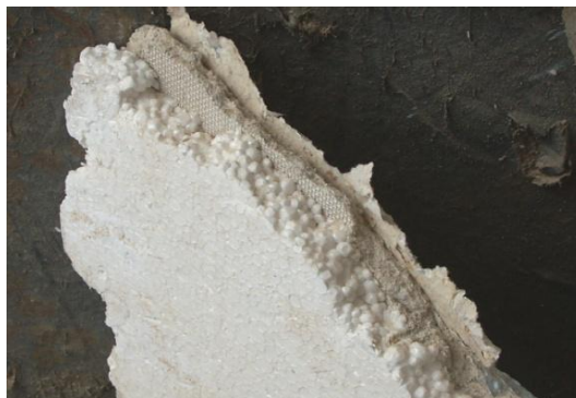
Innendämmsystem: Verbundplatte 1,25 cm Gipskarton auf 1,5 cm Styropor
