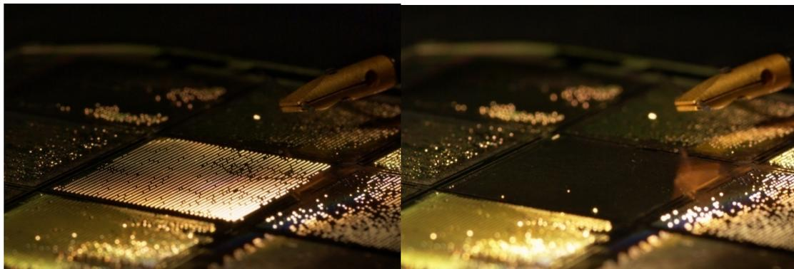
Abb. 2.23: 2cm x 2cm-Segment aktuierbarer Mikrospiegelarrays, bestehend aus rund 4000 Mikrospiegeln (Design: Maskensatz 5). Links: offener Zustand, rechts: geschlossener (aktuierter) Zustand.
