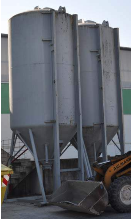
Bild 24: Festbettreaktor in Silobauweise
