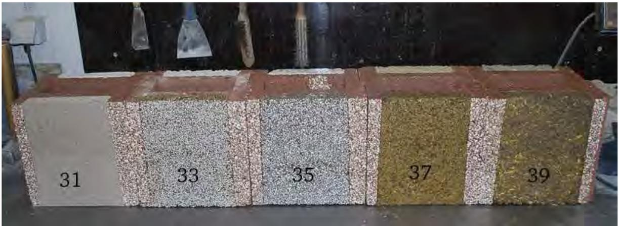
Abbildung 4: Durchtrennte Mauersteine (Dämmmischungen mit Zement als Bindemittel)
