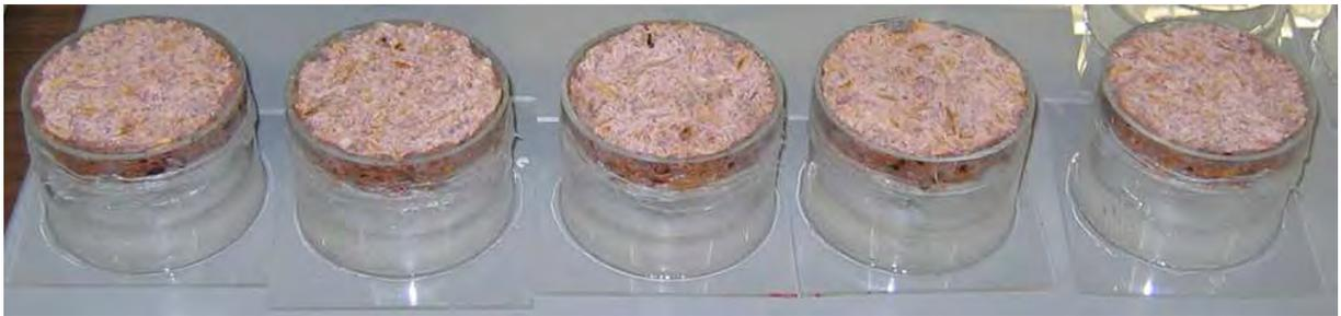
Abbildung 5: Schälchen mit eingebauten Probekörper und Salzlösung
