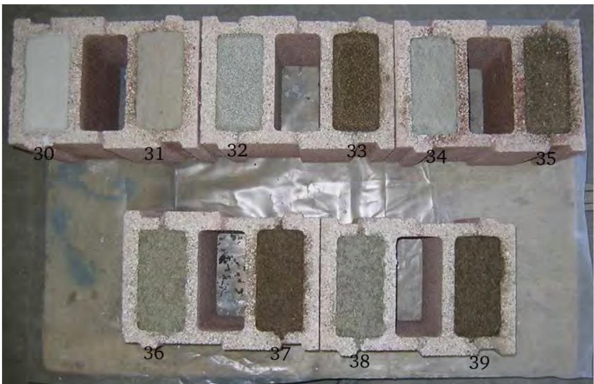
Abbildung 2: Mit Dämmung verfüllte Mauersteine
