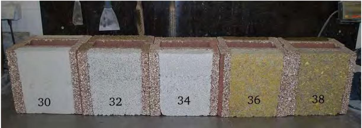
Abbildung 3: Durchtrennte Mauersteine (Dämmmischungen mit Kalk als Bindemittel)
