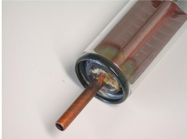
Abbildung 3: Glas-Metall-Verschmelzung zum Versiegeln der Kollektorröhre
