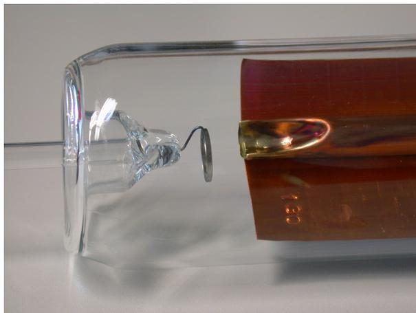
Abbildung 2: Glas-Glas-Verschmelzung zum Versiegeln der Kollektorröhre
