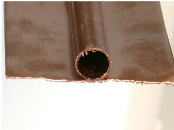
Abbildung 20: Schnitt durch eine montierte Finne
