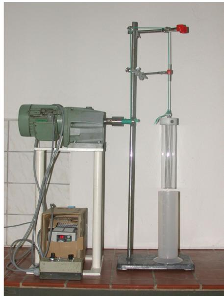
Abbildung 6: Laboranlage zur Glasbeschichtung
