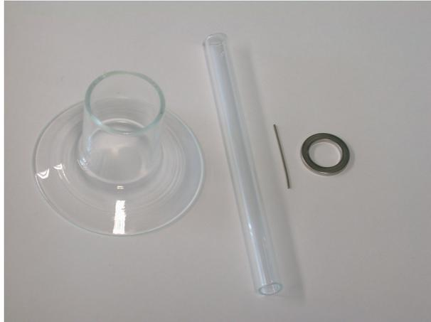
Abbildung 10: Einzelteile des Gestells (v.l.n.r.: Teller, Pumprohr, Haltedraht und Getterring)
