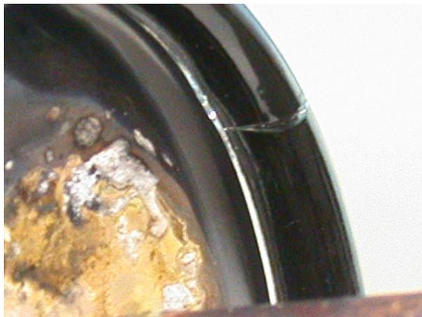
Abbildung 27: Fehlerhafte Glas-Metall-Einschmelzung
