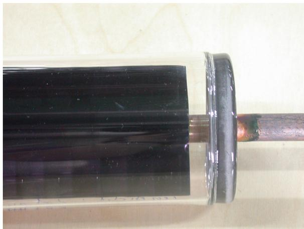
Abbildung 26: Ausgeführte Glas-Metall-Einschmelzung
