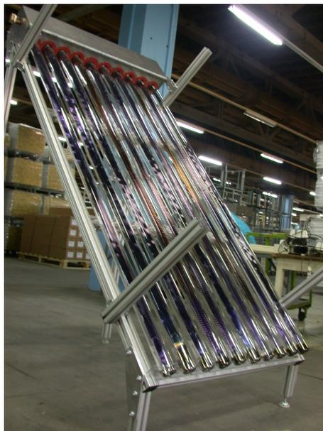
Abbildung 4: Komplett montierte Batterie aus einzelnen Kollektorröhren
