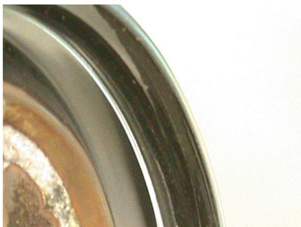
Abbildung 28: Exakt ausgeführte Glas-Metall-Einschmelzung
