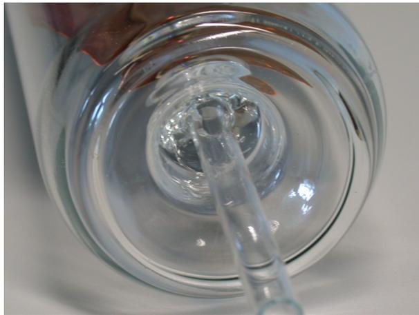
Abbildung 29: Hüllkolben mit eingeschmolzenem Gestell mit Getterring und Pumploch
