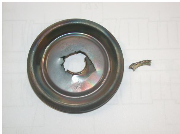
Abbildung 21: Schlechte Lötverbindung (Risse in der Lötstelle und anschließender Bauteilbruch)
