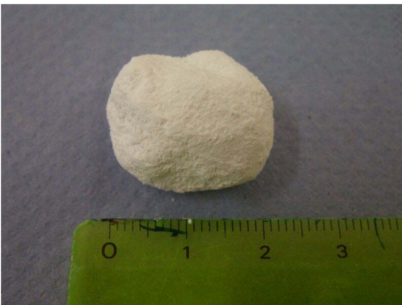
Abbildung 5-29: Pelletierte MgO Hohlkugel mit PS-Kern, Pelletierungsverfahren
