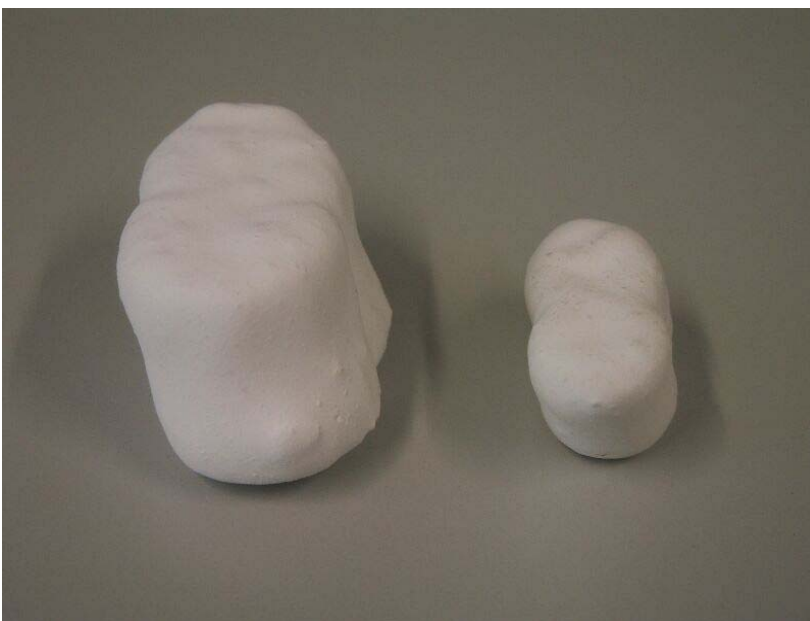
Abbildung 5-27: Probekörper vor und nach dem Brand (weiche Flakes)
