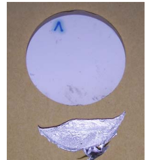
Abbildung 5-5: Kontakthaftung von Mg-Schmelze an verschiedenen ATI-Mischungen
