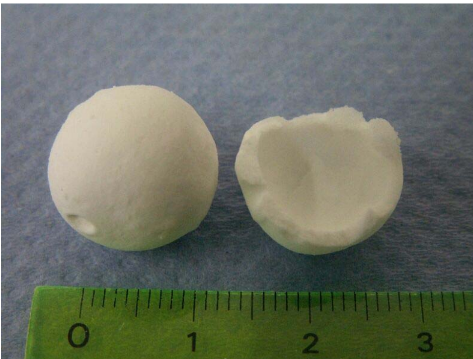
Abbildung 5-34: MgO Hohlkugel, Tauchverfahren, nach Brand bei 1770 °C
