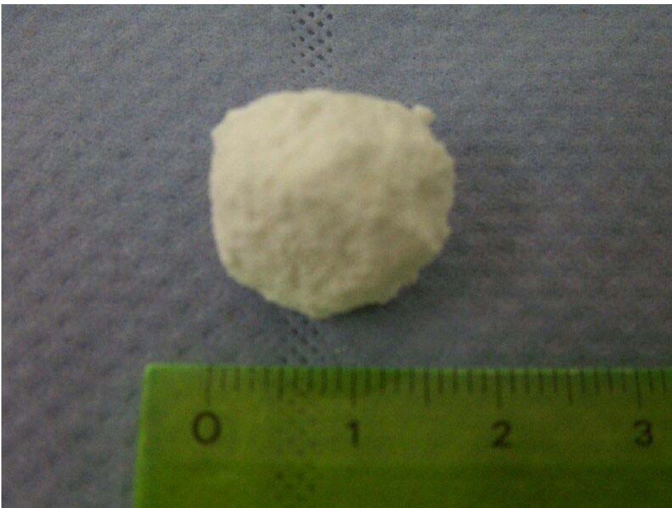
Abbildung 5-32: Pelletierte MgO Hohlkugel, Trägermaterial Watte, nach dem Brand bei 1750°C
