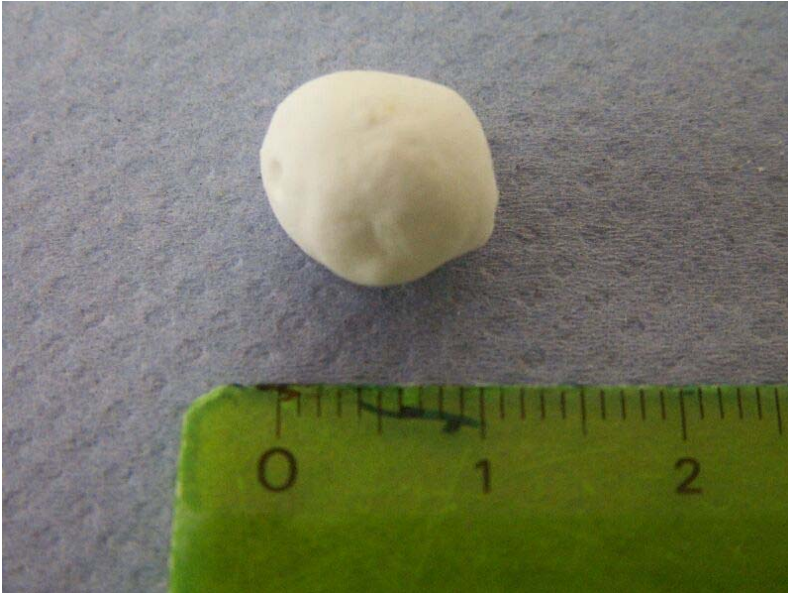
Abbildung 5-28: MgO Hohlkugel mit PS-Kern, Eintauchverfahren, bei 1650°C gebrannt
