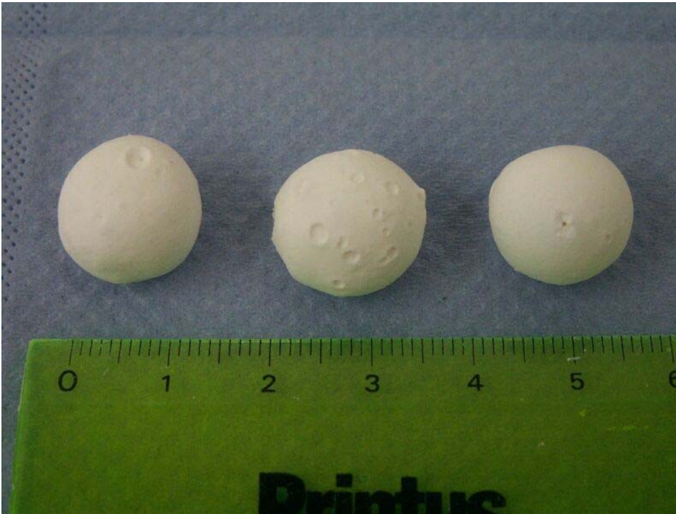
Abbildung 5-33: MgO Hohlkugeln nach Tauchverfahren, Trägermaterial Watte
