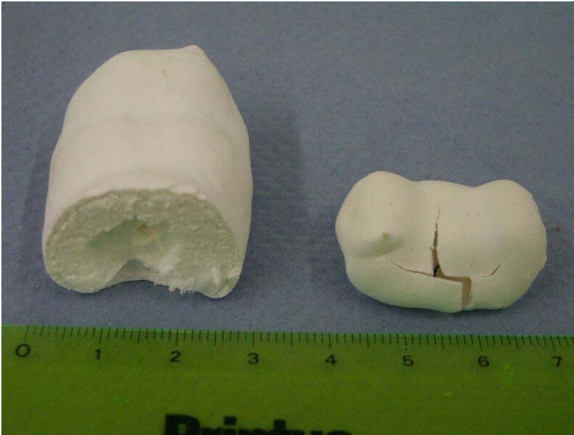
Abbildung 5-26: Probekörper vor und nach dem Brand (feste Flakes)
