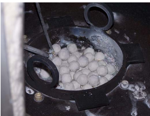
Abbildung 5-44: Schutzgasbegasung unter Einsatz von Hohlkugeln
