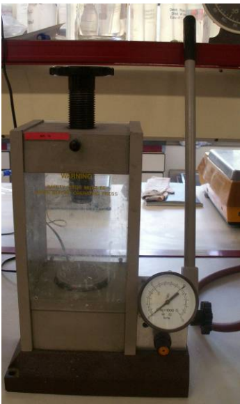
Abbildung 5-14: Hydraulische Handpresse für die Herstellung der Test-Proben
