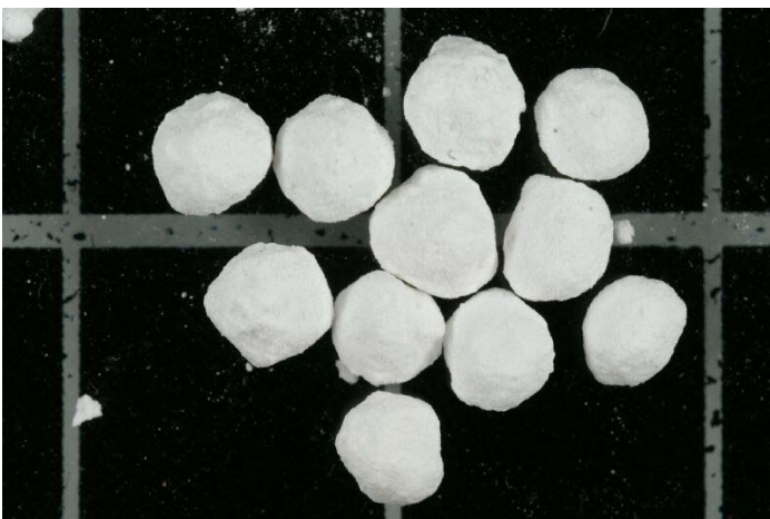
Abbildung 5-25: gesinterte Hohlkugeln nach dem Eintauchverfahren
