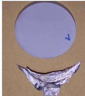
Abbildung 5-5: Kontakthaftung von Mg-Schmelze an verschiedenen ATI-Mischungen
