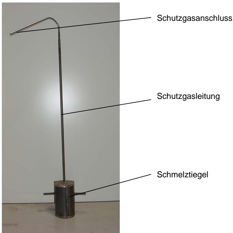
Abbildung 5-6: Vorrichtung für Zeitstandversuche
