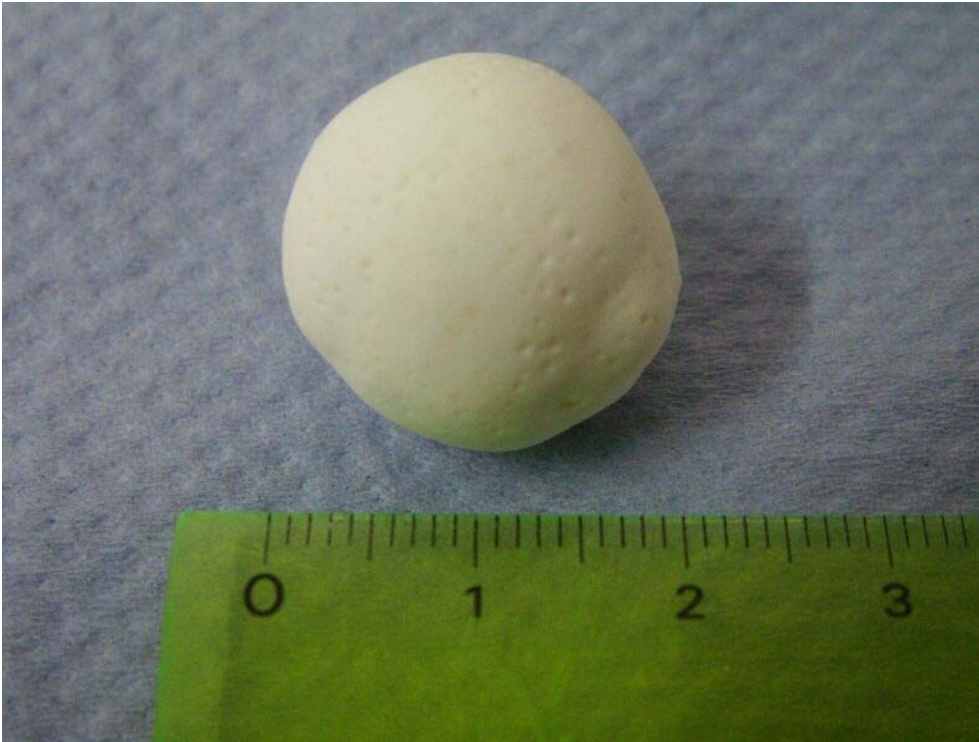
Abbildung 5-35: \text{Al}_2\text{O}_3 Hohlkugel, Tauchverfahren, nach Brand bei 1770 °C
