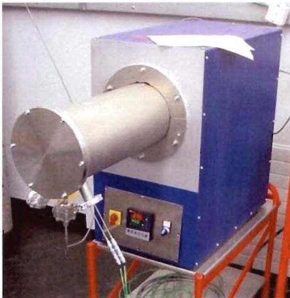
Abbildung 1: Vakuum-Rohröfen für PDP-Versuche
