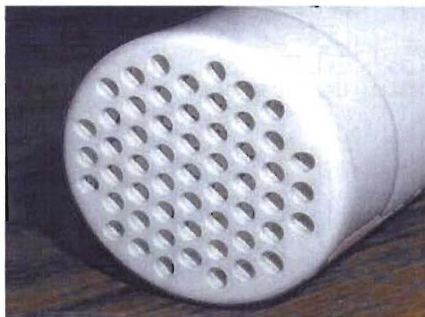
**Abbildung 6: Keramikmembran (Fa. NGK, Japan)**
